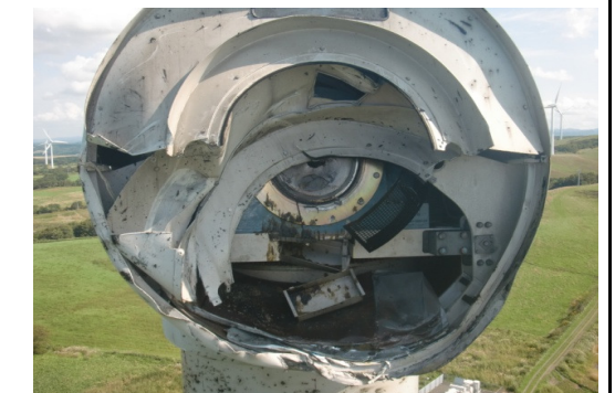
図2-3 主軸破断面(ナセル側)
