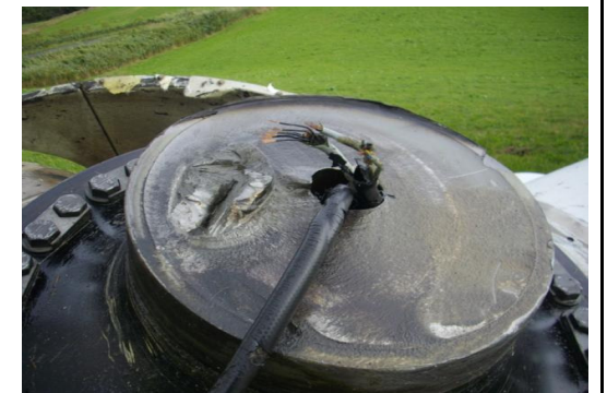
図2-2 主軸破断面(ハブ側)
