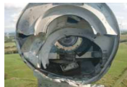
図-5 主軸破断面(ナセル側)
