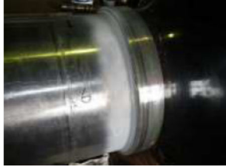
図-17 浸透探傷検査の良好例 (浜頓別2号)
