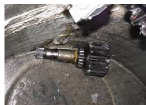
写真1 脱落したピニオンギア
