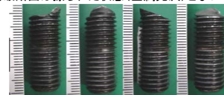
写真5 破断ボルト外観
