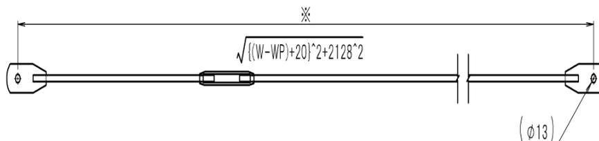
注) 図中の※印のある寸法は、太陽電池モジュールのサイズによって異なる。
