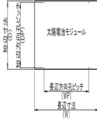
注) 太陽電池モジュール固定孔ピッチは、長辺方向1,400mm以下、短辺方向1,050mm以下とする。
