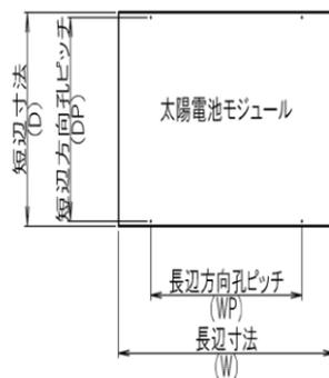
注) 太陽電池モジュール固定孔ピッチは、長辺方向 1,400mm以下、短辺方向1,050mm以下とする。
