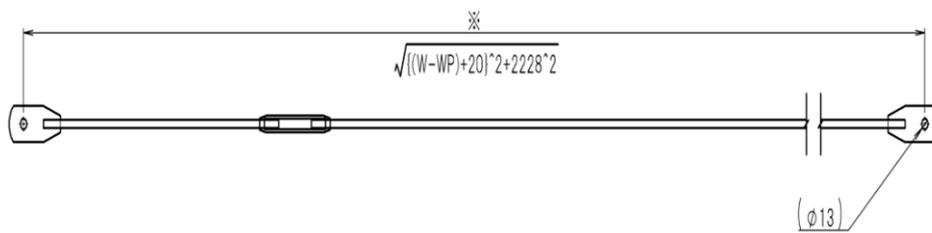
注) 図中の※印のある寸法は、太陽電池モジュールのサイズによって異なる。
