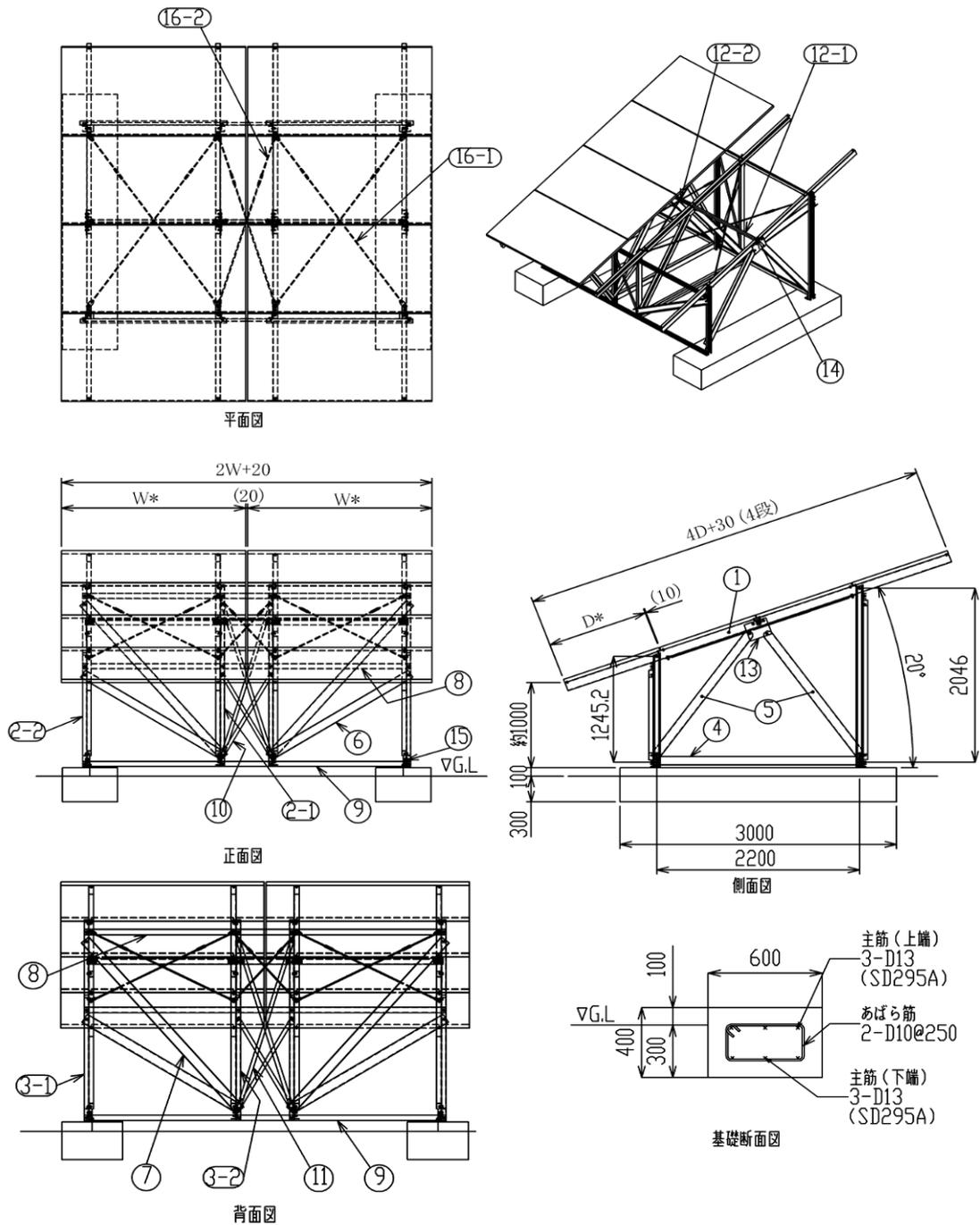
※ 太陽電池モジュールの長辺長さWは2,000mm以下、短辺長さDは1,100mm以下、面積 $W \times D$ は $2\text{m}^2$ 以下とする。
