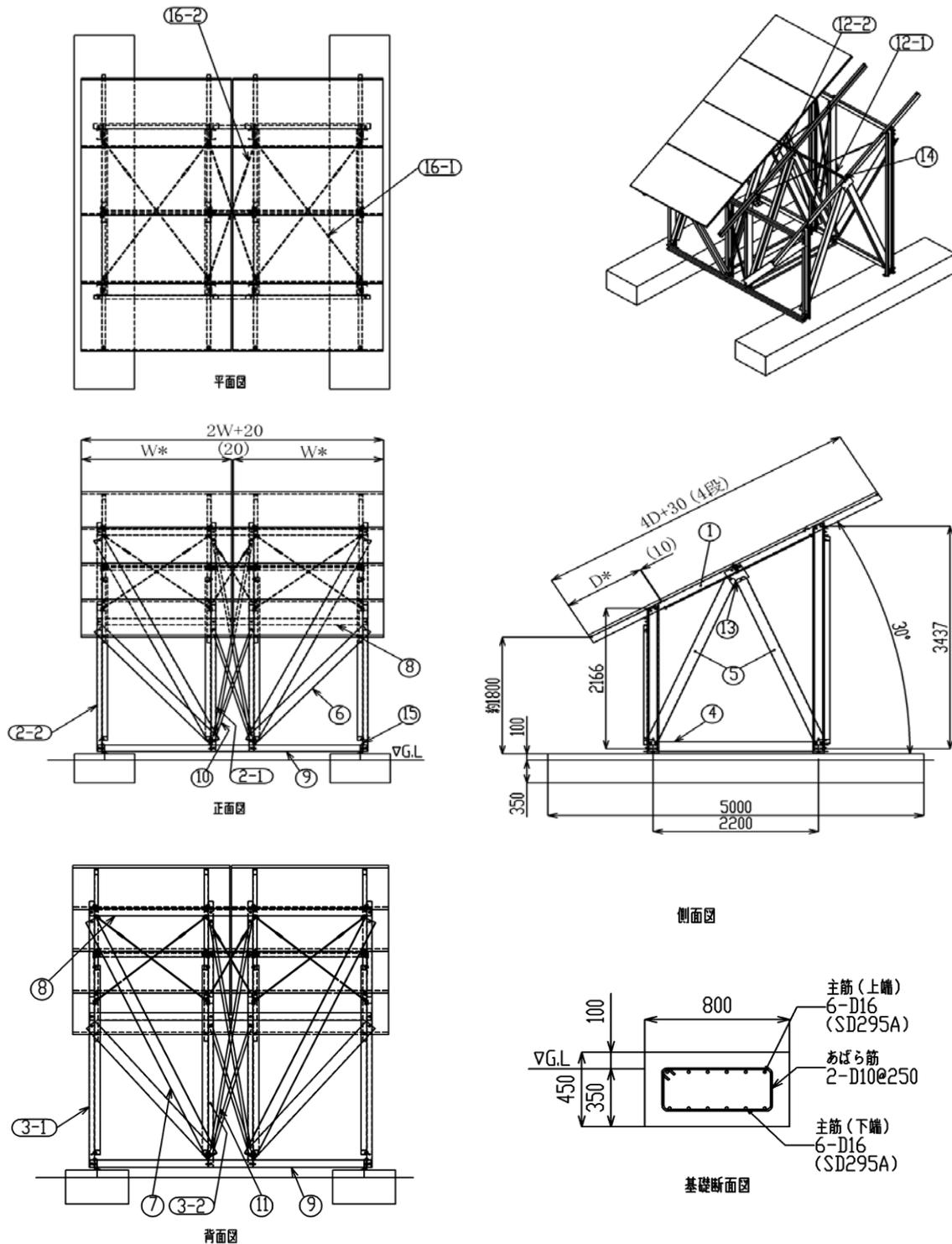
※ 太陽電池モジュールの長辺長さWは2,000mm以下、短辺長さDは1,100mm以下、面積W×Dは2m<sup>2</sup>以下とする。
