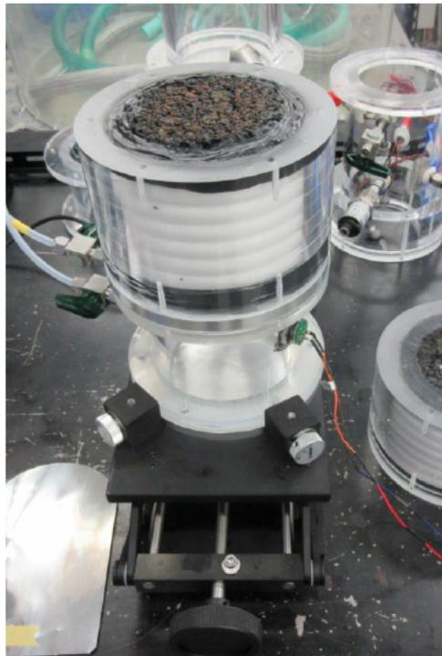
図 4-2-2 拡散係数計測装置の外観
