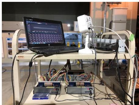
図 6-2-4 地中濃度計測表示部外観
