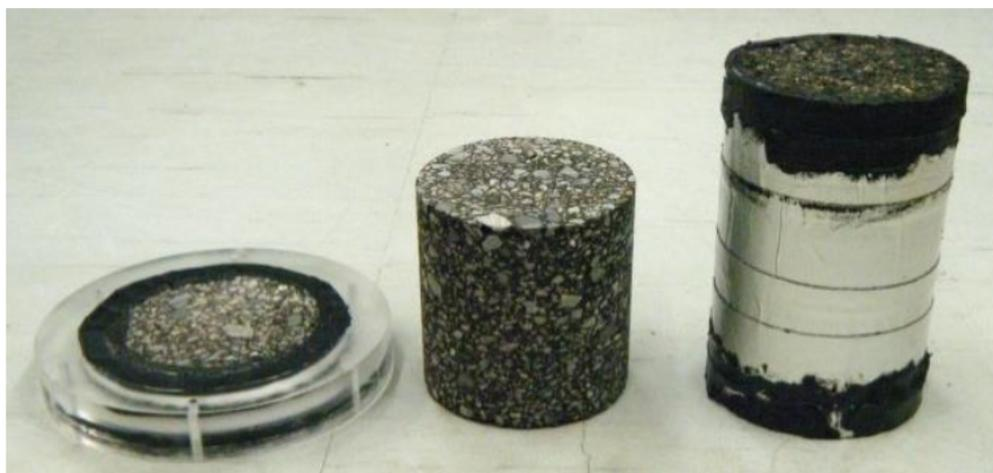
図 5-1-3 アスファルトコアの外観 (直径 $\phi$ 100mm)
