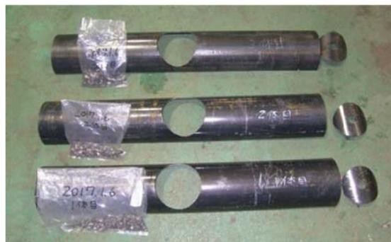
図 2.3-4 貫通試験後の試験体
