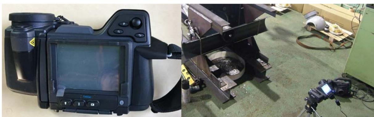
図2.2-4 赤外線サーモグラフィカメラ外観および使用状況
