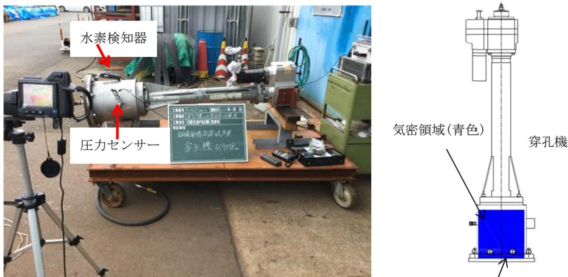
図1.3-2 穿孔機気密試験
