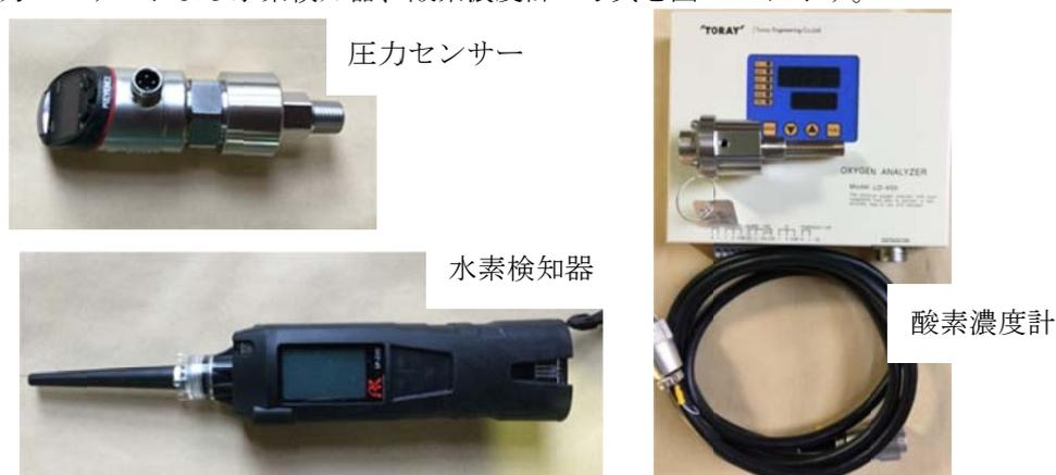
図1.2-2 圧力センサー、水素検知器、酸素濃度計
