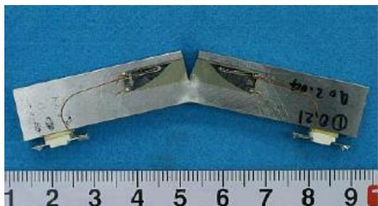
＜疲労き裂進展試験後の試験片外観＞
