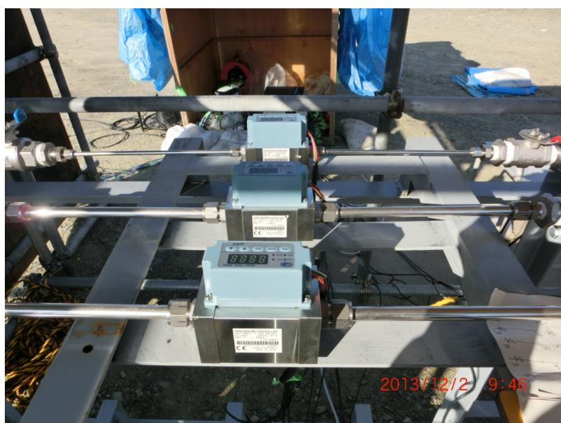
図 2.1.9 圧力計、熱電対、流量計
