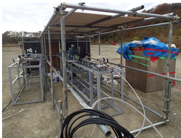
図 2.1.5 圧力流量調整装置
