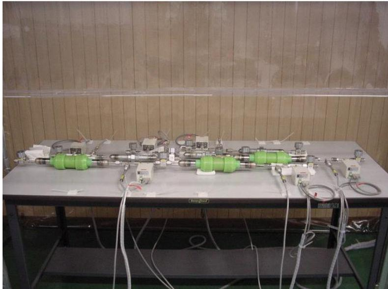
図3. 4. 4-2 状態調整の状況 (RSユニオン及びPCメカニカル継手の例)
