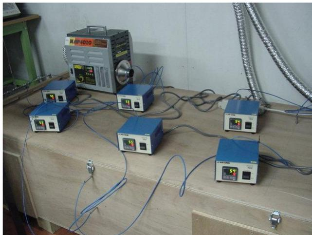
図3. 4. 3-3 ドライ処理箱内の温度測定状況
