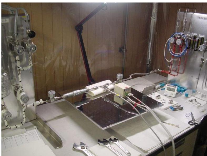
図3. 4. 4-1 接続体とガスパネルの接続状況（ねじ込み継手の例）
