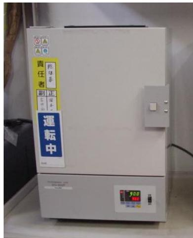
図2. 3-1 耐久加速処理用恒温槽
