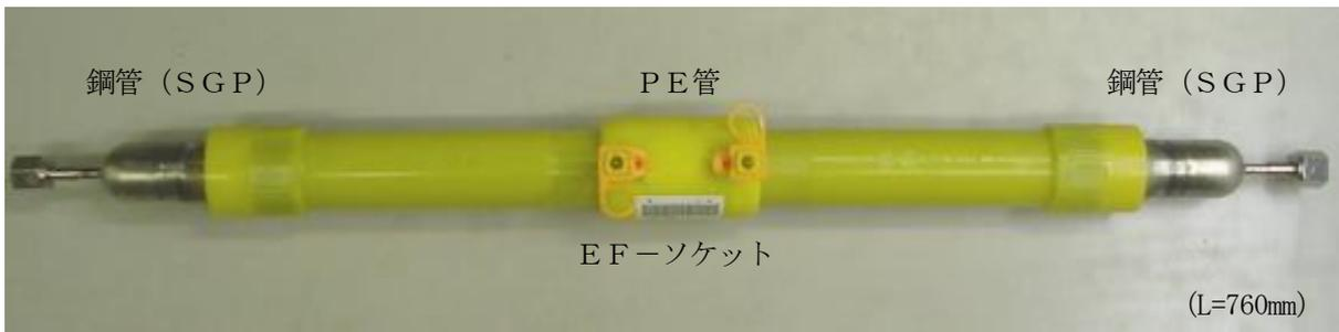
図3. 4. 2-6 鋼管ライザー管
