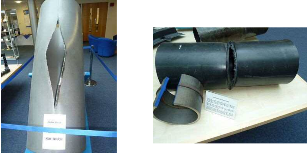
図3. 8 金属材料および高分子材料不具合再現モデル
