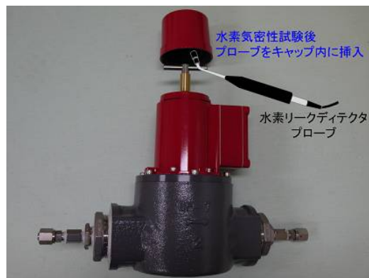
図 4-10 水素気密性試験後の水素リーク部位の確認状況
