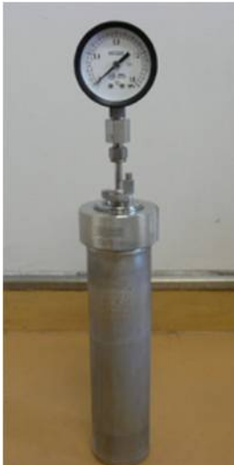
図 2-3 耐圧容器外観
