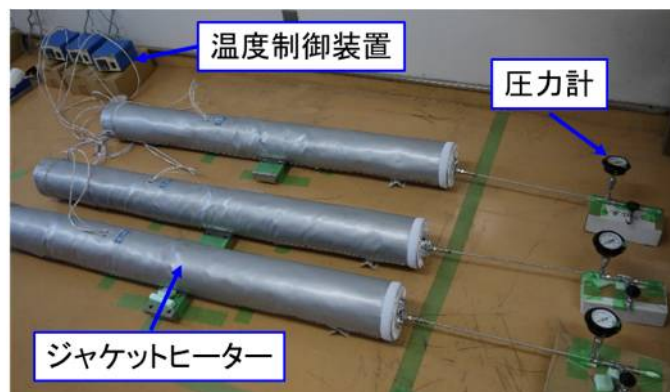
図 3-15 ジャケットヒーターを用いた促進劣化処理
