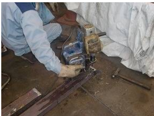
クロスゲージ製作状況 部品作成
