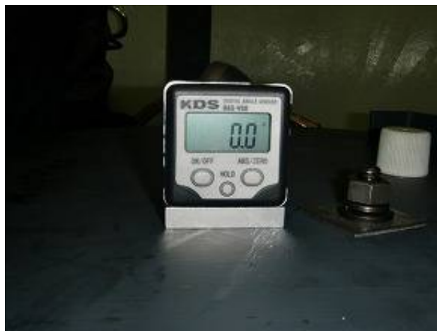
クロスゲージ水平設置確認状況
