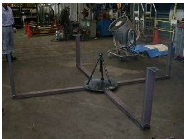
クロスゲージ製作状況 組立確認
