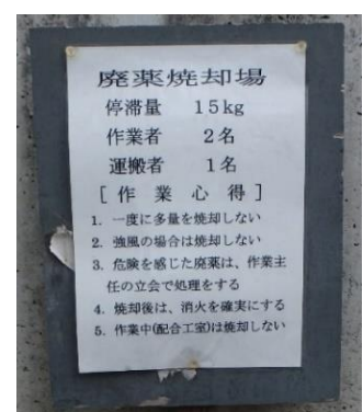
図 6 廃薬焼却場の掲示板
