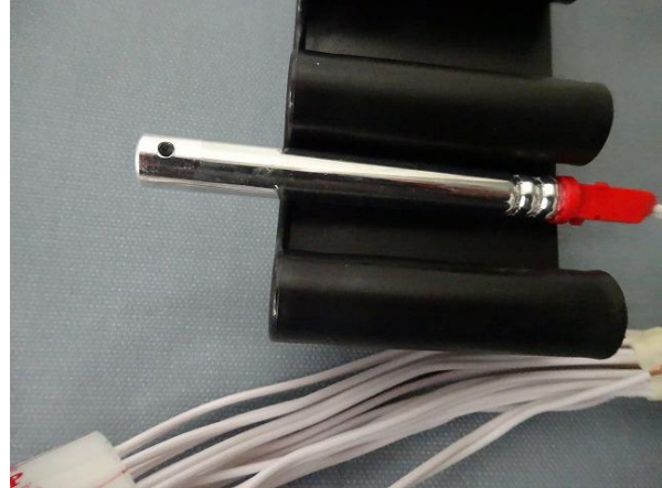
図 5.1.1.2-4 KONEL 雷管模擬品（側面の穴）
