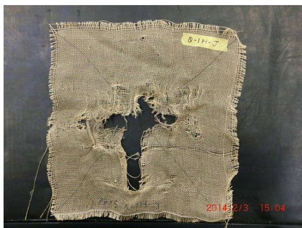
6 号雷管 1 個、SO=0、水平 (4-Ts15-0-1H-J)
