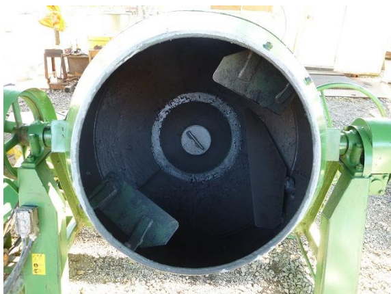
図 5.1.3.2-6 角を削った攪拌羽根 3 枚 攪拌物を表 5.1.3.2-5 に示す。
