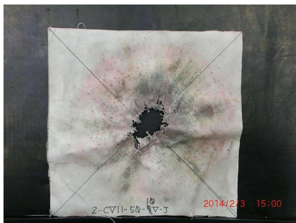
6 号雷管 10 個、SO=50、垂直 (4-CV11-50-10V-J)
