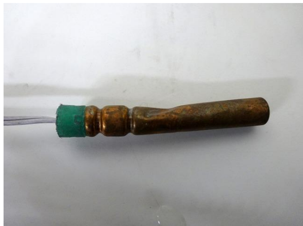
図 5.1.1.3-3 唯一変形した模擬雷管 （実験 No. 1-#100- d -J）
