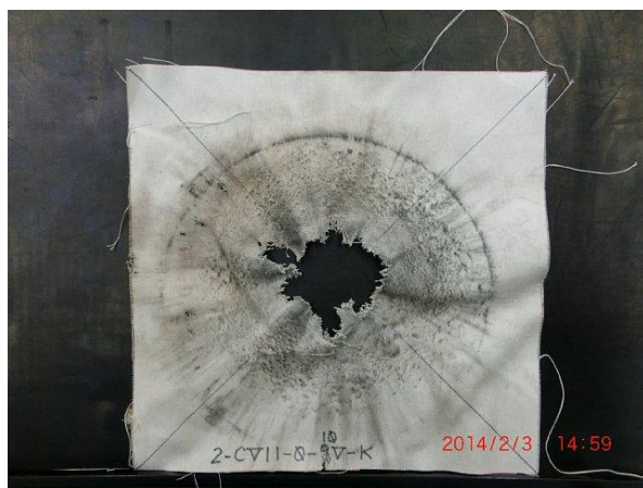
KONEL 雷管 10 個、SO=0、垂直 (4-CV11-0-10V-K)
