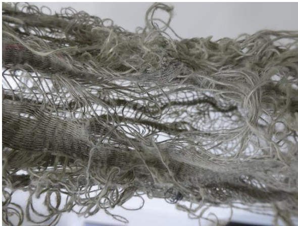
攪拌でぼろぼろになった箇所状況 1
