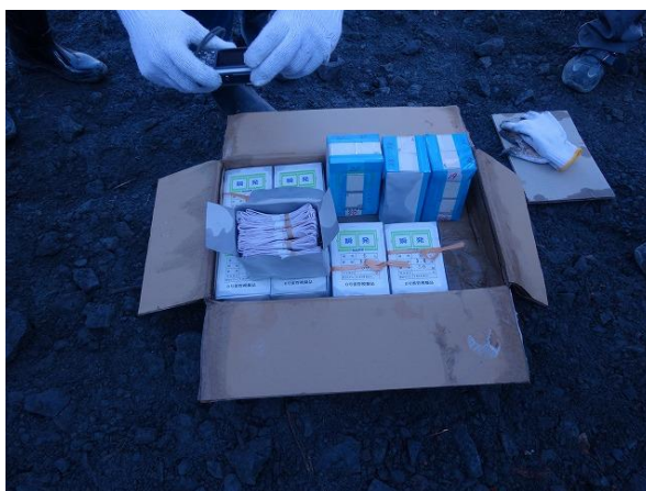
実験後の大箱内の 6 号雷管模擬品
