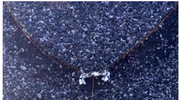
模擬土砂群落下後の包装実験体
