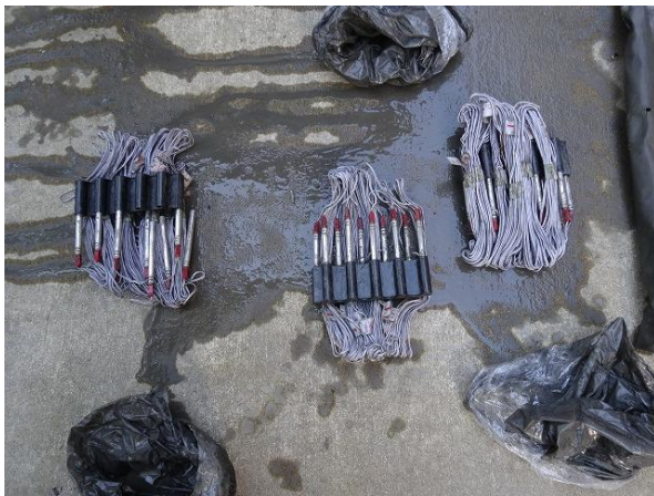
実験後の KONEL 雷管の状況 1
