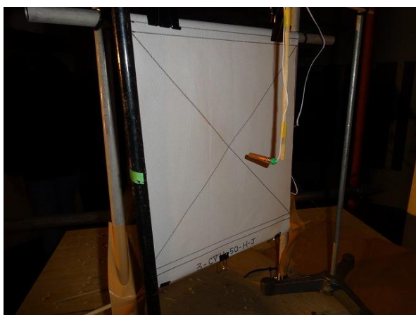
雷管設置状況
