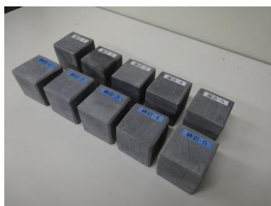
打撃圧試験体(50mm 角)
