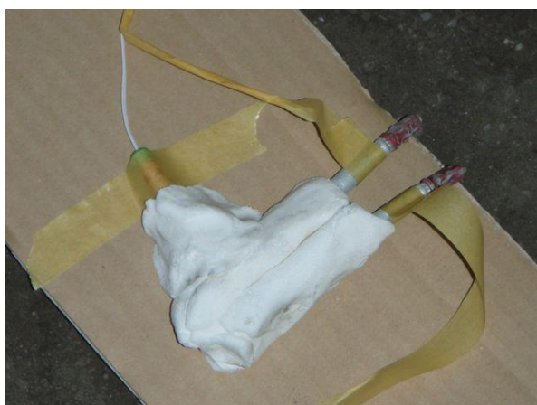
脚線のとれた KONEL 雷管 2個（C-4 150g）処理前の状況
