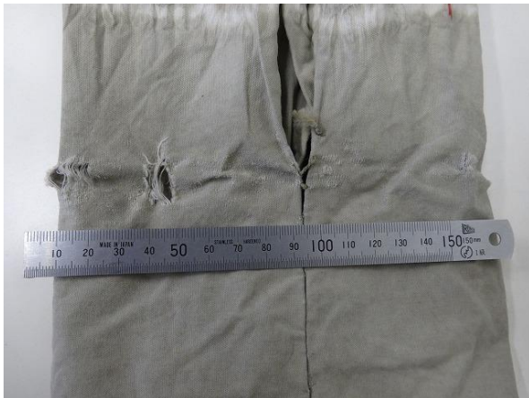
攪拌で開いた穴の状況 1
