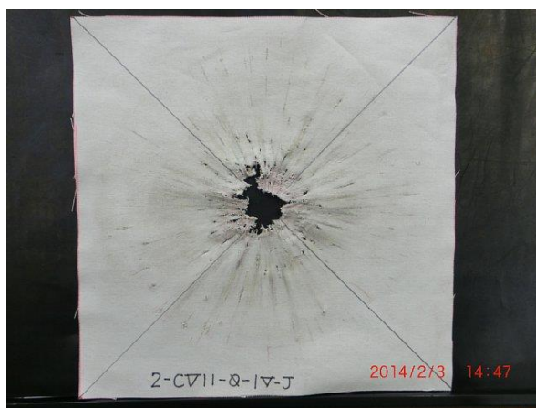
6 号雷管 1 個、SO=0、垂直 (4-CV11-0-1V-J)
