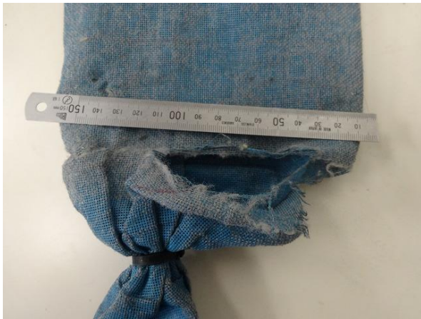
実験で裂けた箇所の状況 1
