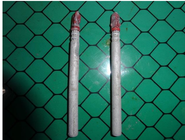
図 5.1.2.2-3 脚線が取れ、変形した KONEL 雷管（実験 No.1-Ts15-b-K）
