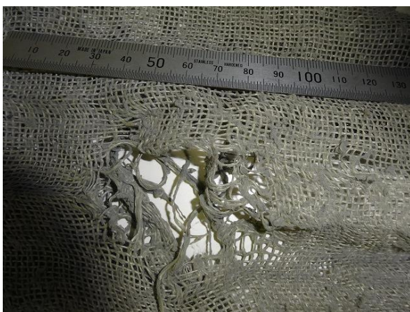
実験後の Ts15 穴の状況 1
