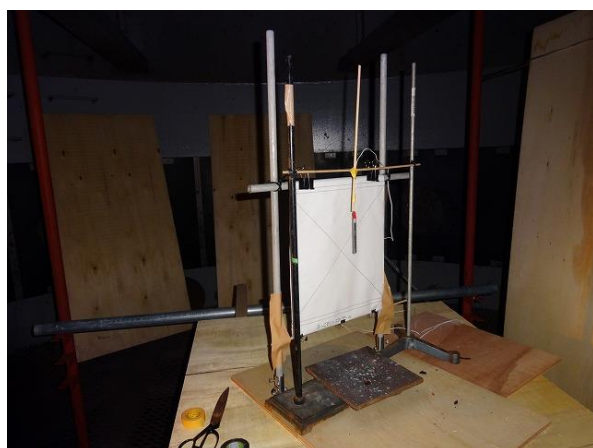
雷管設置状況
