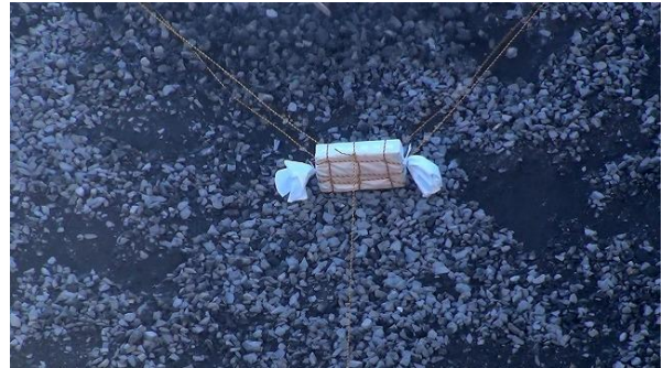
模擬土砂落下前の包装実験体
