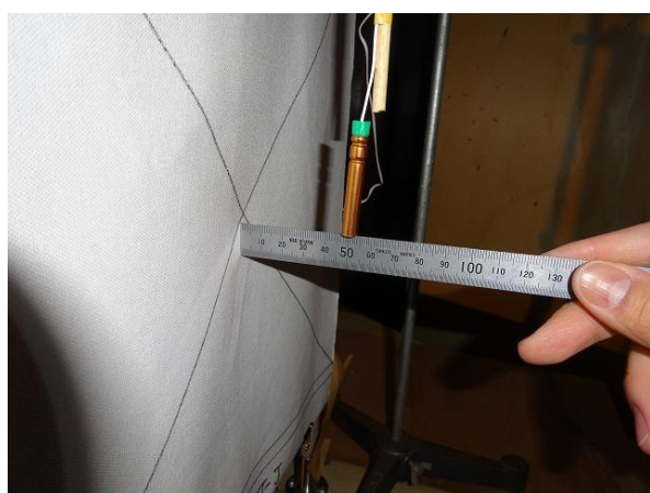
雷管設置状況
