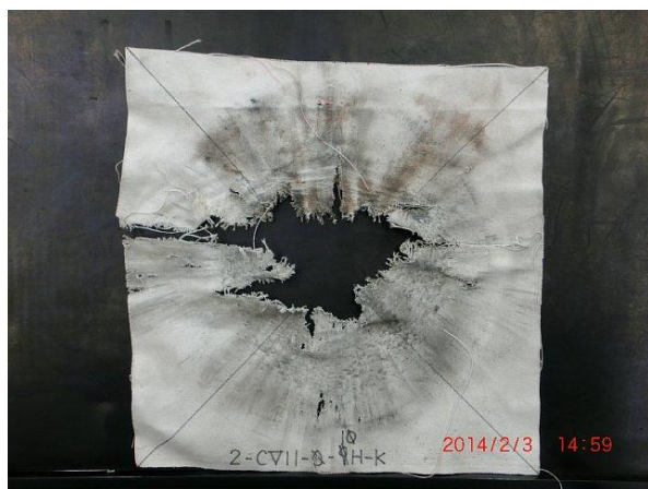
KONEL 雷管 10 個、SO=0、水平 (4-CV11-0-10H-K)
