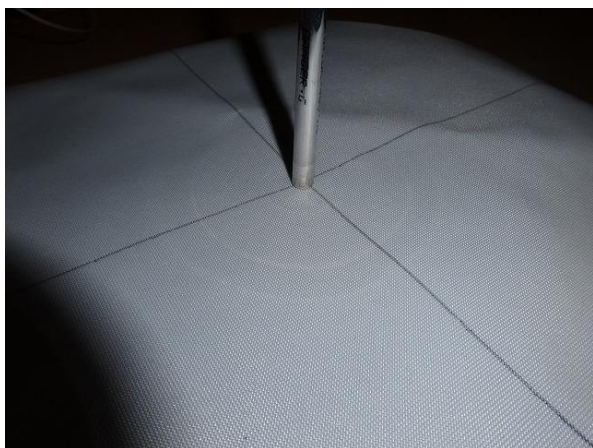
雷管設置状況
