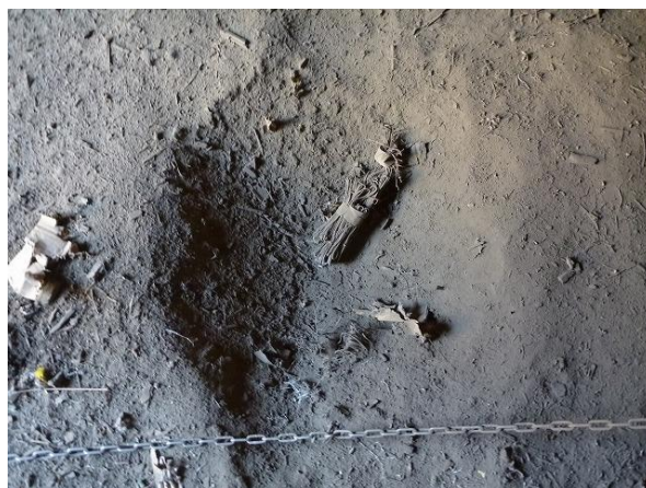
6号雷管 50個（C-4 120g）処理後の状況
