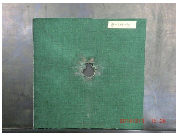
KONEL 雷管 1 個、SO=0、水平 (4-B781-0-1H-K)
