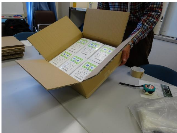
図 5.1.3.2-1 6号雷管模擬品を詰めた段ボール箱
