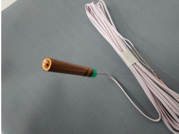
図 5.1.1.2-3 6号雷管模擬品（先端の穴）
