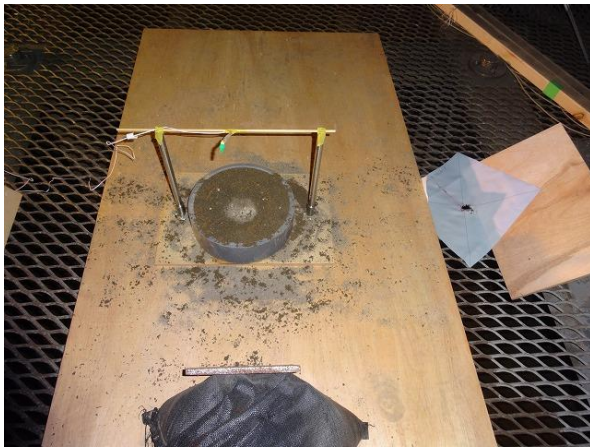
雷管設置状況
