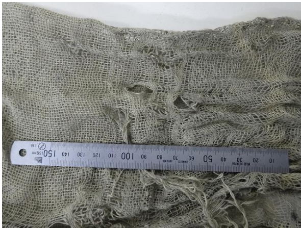
攪拌で開いた穴の状況 1
