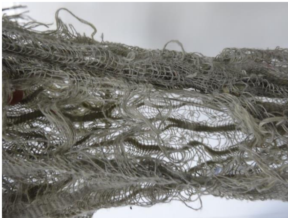
攪拌でぼろぼろになった箇所状況 1
