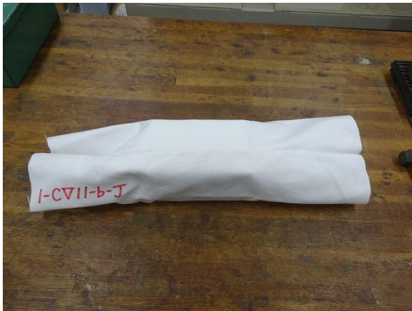
6号雷管を挿入した包装材 CV11
