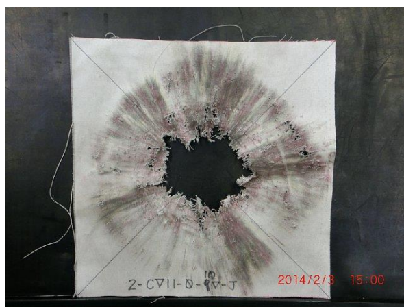
6 号雷管 10 個、SO=0、垂直 (4-CV11-0-10V-J)
