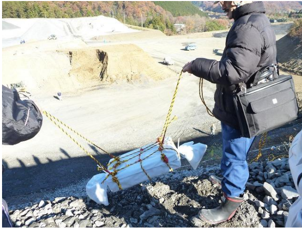
包装実験体の設置作業状況
