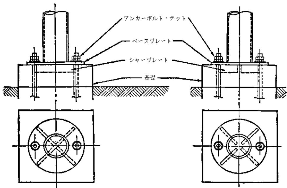
(7) 平底円筒形貯槽のアンカーストラップの取付けは、次の図に示す例により行う。
