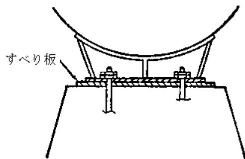
(6) 球形貯槽のアンカーボルトの取付けは、次の図に示す例により行う。
