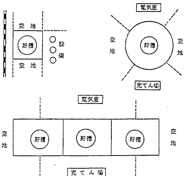
(2) 防液堤に関する一般高圧ガス保安規則関係例示基準5及び液化石油ガス保安規則例示基準10中集合防液堤に複数の貯槽を設置する場合の防液堤の容量についての特例を定めているが、この場合において、これらの基準2の項（容量）の表備考により間仕切り防液堤が必要であり、この限りにおいて、この間仕切り防液堤自体が一つ一つの貯槽の防液堤とみなされるものである。この場合において、既に間仕切りが設置されており、当該間仕切りがおおむね備考に定める容量に応じて設けられている場合には、当該間仕切りをもって基準に適合する間仕切りとみなす。
