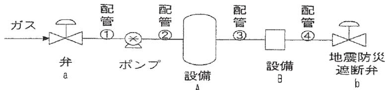
$$\text{内容積} = \text{配管 } ② \text{ の内容積} + \text{配管 } ③ \text{ の内容積} + \text{配管 } ④ \text{ の内容積} \\ + \text{地震防災遮断弁 } b \text{ の内容積の } 1/2$$
