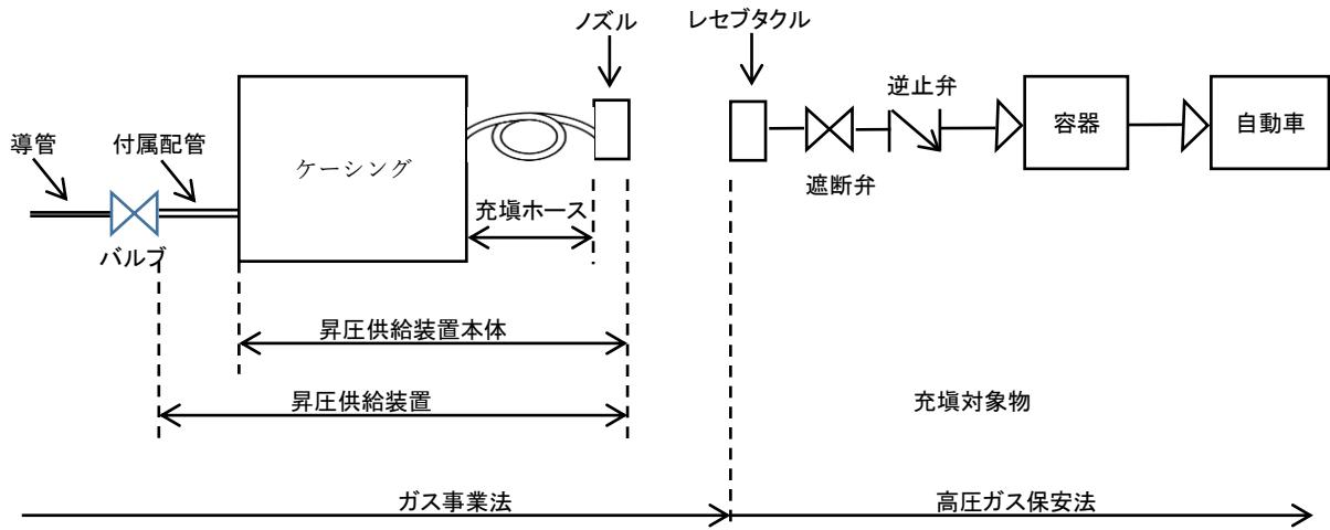
第1項第24号中「液化天然ガスを燃料として使用する車両に固定した燃料装置用容器」について
