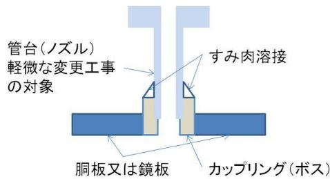
(4) 「溶接の方法がすみ肉溶接であり、かつ、溶接に用いられる母材が告示で定める要件を満たすもの（特定設備検査規則第29条ただし書に該当する場合に限る。）」とは、①取替えの工事の溶接方法がすみ肉溶接であること、②その溶接の条件が特定設備検査規則第29条ただし書に規定される応力除去が必要でない場合であること、③溶接する母材の種類は告示で定める要件に適合することの3つの条件が全て揃っていることをいう。
