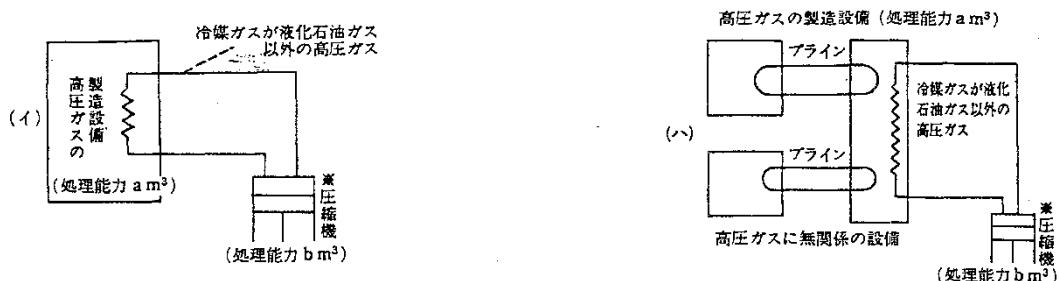
**備考** いわゆる付属冷凍の圧縮機から第一種保安物件等に対する距離の算定は、当該附属冷凍の処理能力 ( $b\text{m}^3$ ) に対応する距離をとること。
