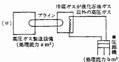
備考 いわゆる付属冷凍の圧縮機から第一種保安物件等に対する距離の算定は、当該附属冷凍の処理能力 ( $b\text{m}^3$ ) に対応する距離をとること。
