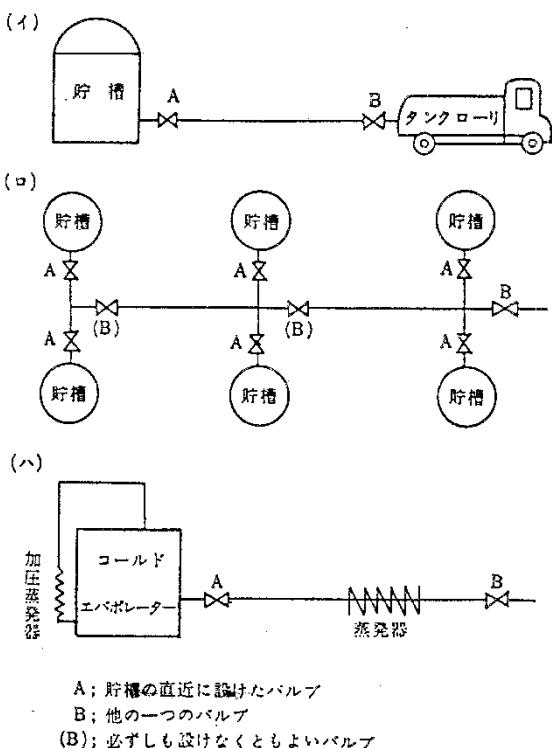
12. 第1項第32号中「可燃性物質を取り扱う設備」とは、次に掲げるものを製造し、貯蔵し、又は取り扱う設備とする。
