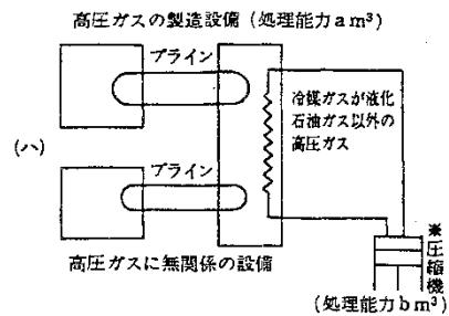
備考 いわゆる付属冷凍の圧縮機から第一種保安物件等に対する距離の算定は、当該附属冷凍の処理能力 ( $b\text{m}^3$ ) に対応する距離をとること。
