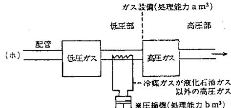
備考 いわゆる付属冷凍の圧縮機から第一種保安物件等に対応する距離の算定は、当該附属冷凍の処理能力 ( $b\text{m}^3$ ) に対応する距離をとること。
