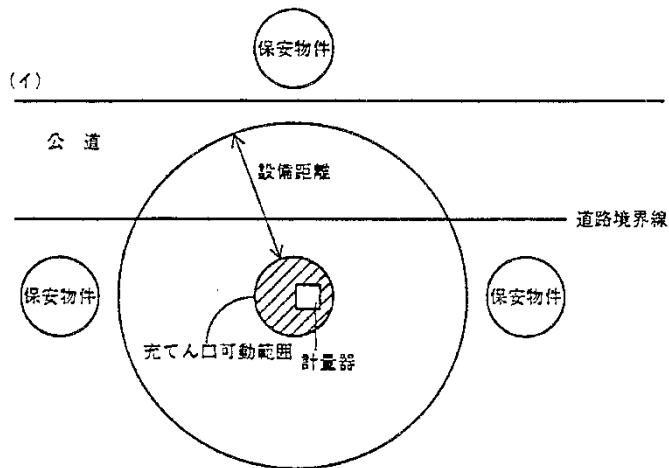
(ロ) 図(ロ)に示すように容器の停止する範囲をディスペンサーの位置とみなし、設備距離を確保すること。
