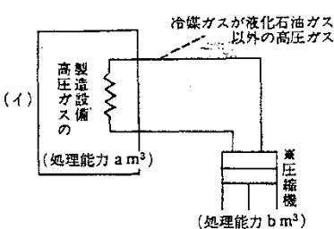
備考 いわゆる付属冷凍の圧縮機から第一種保安物件等に対する距離の算定は、当該附属冷凍の処理能力 ( $b\text{m}^3$ ) に対応する距離をとること。
