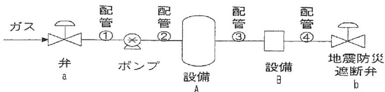
$$\text{内容積} = \text{配管②の内容積} + \text{配管③の内容積} + \text{配管④の内容積} \\ + \text{地震防災遮断弁 } b \text{ の内容積の } 1/2$$
