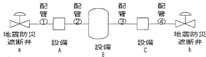
$$\text{内容積} = \text{地震防災遮断弁 } a \text{ の内容積の } 1/2 + \text{配管①の内容積} + \text{配管②の内容積} \\ + \text{配管③の内容積} + \text{配管④の内容積} + \text{地震防災遮断弁 } b \text{ の内容積の } 1/2$$
