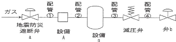
$$\text{内容積} = \text{地震防災遮断弁 } a \text{ の内容積の } 1/2 + \text{配管①の内容積} + \text{配管②の内容積} \\ + \text{配管③の内容積} + \text{減圧弁の内容積の } 1/2$$
