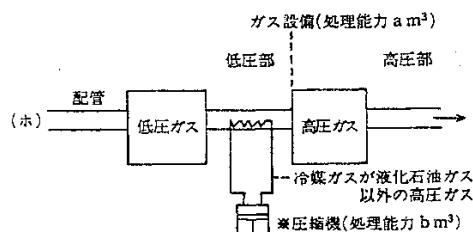
**備考** いわゆる付属冷凍の圧縮機から第一種保安物件等に対応する距離の算定は、当該附属冷凍の処理能力 ( $b\text{m}^3$ ) に対応する距離をとること。
