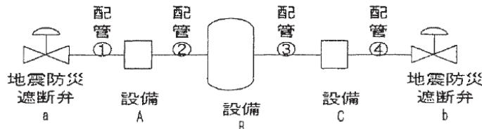
$$\text{内容積} = \text{地震防災遮断弁 } a \text{ の内容積の } 1/2 + \text{配管 } ① \text{ の内容積} + \text{配管 } ② \text{ の内容積} \\ + \text{配管 } ③ \text{ の内容積} + \text{配管 } ④ \text{ の内容積} + \text{地震防災遮断弁 } b \text{ の内容積の } 1/2$$
