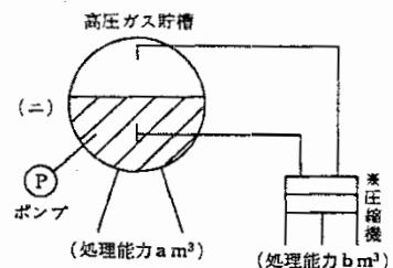
備考 いわゆる付属冷凍の圧縮機から第一種保安物件等に対する距離の算定は、当該附属冷凍の製造設備の処理能力 ( $a+b\text{m}^3$ ) に対応する距離をとること。
