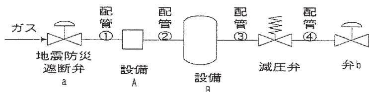
$$\begin{aligned} \text{内容積} = & \text{地震防災遮断弁 } a \text{ の内容積の } 1/2 + \text{配管①の内容積} + \text{配管②の内容積} \\ & + \text{配管③の内容積} + \text{減圧弁の内容積の } 1/2 \end{aligned}$$
