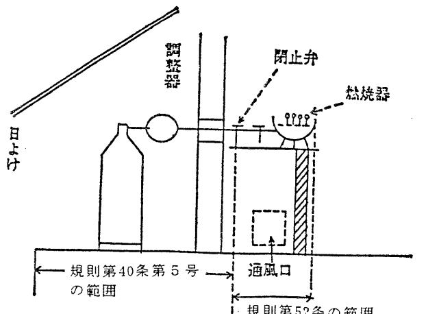
備考 調整器と燃焼器との間に多数の閉止弁があるときは、上図のごとく消費者における最初の閉止弁を「閉止弁」と解する
