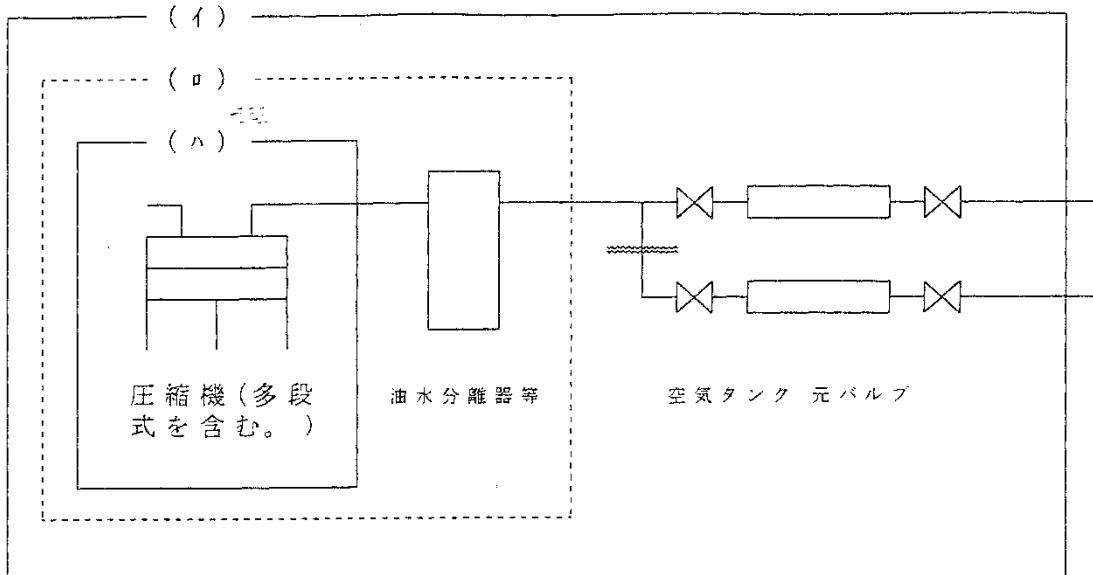
「温度35度においてゲージ圧力5メガパスカル」とは、空気タンクを有する圧縮装置（上図の（イ）のケース）については、空気タンク内の圧力を温度35°Cにおける圧力に換算した圧力とし、空気タンクを有しない圧縮装置（上図（ロ）又は（ハ）のケース）については、圧縮機の吐出し圧力を温度35°Cにおける圧力に換算した圧力とする。
