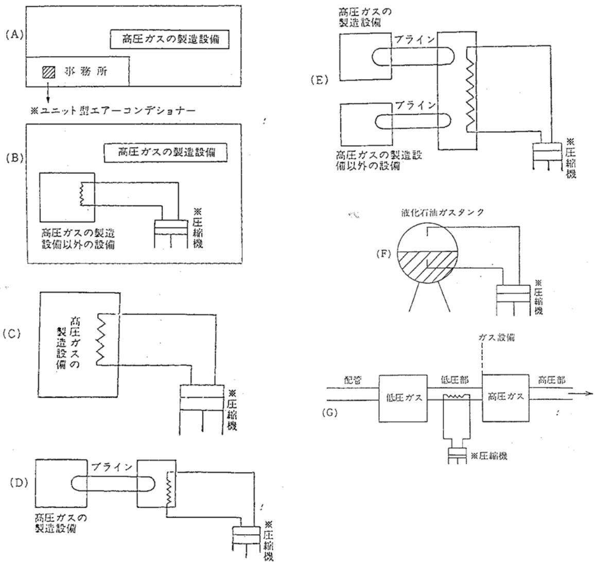
なお、(D)及び(E)の\*印を付した間接冷却式の付属冷凍設備の本体及び本体に取り付けられたブラインの第一継手の範囲における機器の製造に係る技術上の基準については本規則第64条の適用を受けることができ、この場合、当該設備の製造のための施設の位置、構造及び設備に係る技術上の基準（製造施設に係る技術上の基準を除く。）については、一般高压ガス保安規則等の技術上の基準中で本規則の技術上の基準を準用することとする。
