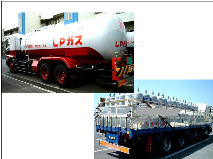
図Ⅱ-30 高圧ガスの移動
