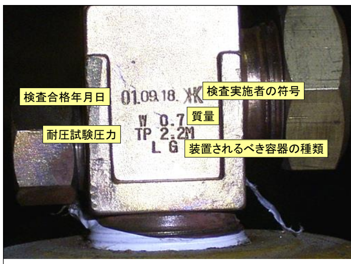
図Ⅱ-50 液化酸素容器用バルブの刻印
