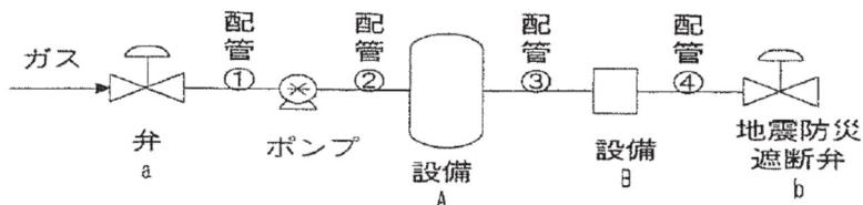
$$\text{内容積} = \text{配管②の内容積} + \text{配管③の内容積} + \text{配管④の内容積} \\ + \text{地震防災遮断弁 } b \text{ の内容積の } 1/2$$
