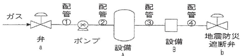
$$\text{内容積} = \text{配管 } 2 \text{ の内容積} + \text{配管 } 3 \text{ の内容積} + \text{配管 } 4 \text{ の内容積}$$
