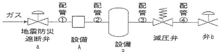
$$\text{内容積} = \text{地震防災遮断弁 } a \text{ の内容積の } 1/2 + \text{配管 } 1 \text{ の内容積} + \text{配管 } 2 \text{ の内容積}$$
