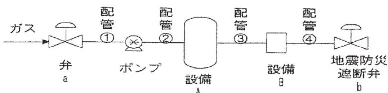
$$\text{内容積} = \text{配管 } 2 \text{ の内容積} + \text{配管 } 3 \text{ の内容積} + \text{配管 } 4 \text{ の内容積}$$
