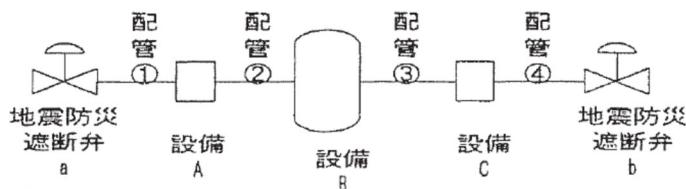
$$\text{内容積} = \text{地震防災遮断弁 } a \text{ の内容積の } 1/2 + \text{配管 } 1 \text{ の内容積} + \text{配管 } 2 \text{ の内容積}$$
