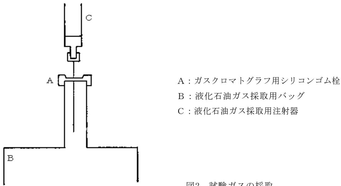
図2 試験ガスの採取
