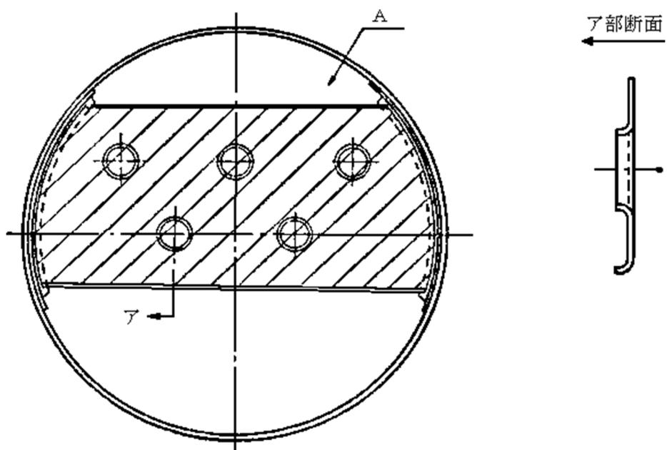
注 防波板の面積（斜線部に設けた穴がア部断面に示すような補強を考慮した構造である場合はその面積を含む。）は、容器の横断面積の40%以上であること。
