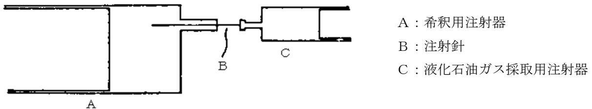
図3 試験ガスの希釀操作
