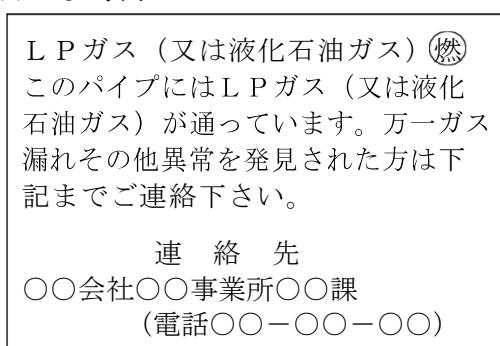
7. 導管（地盤面下埋設）の標識は、次の各号の基準によるものとする。
