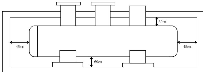
図－1 貯槽と貯槽室のふた、側壁及び底板との距離
