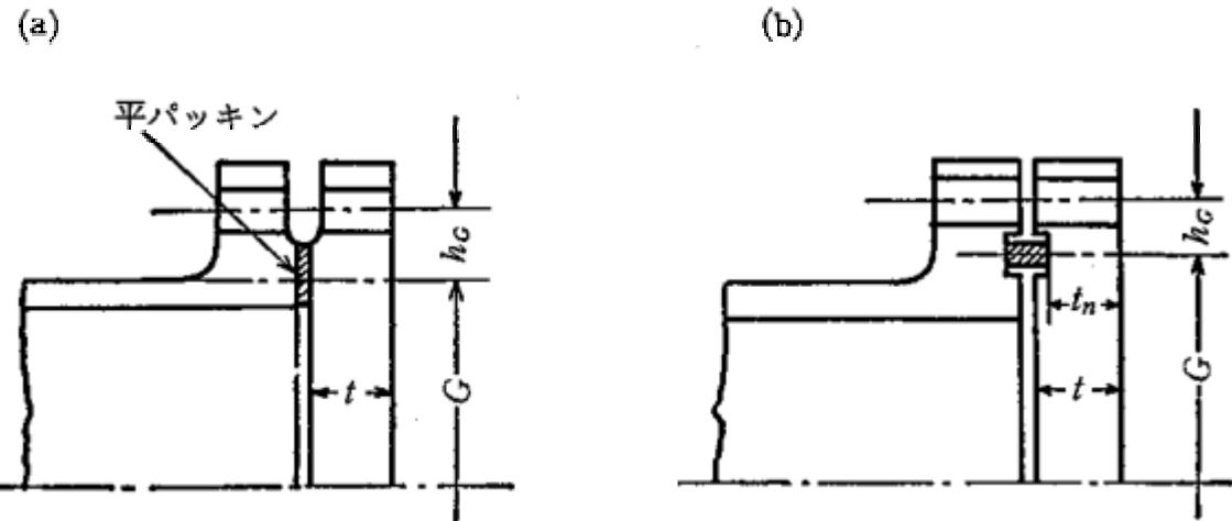
(2) 図23-4(b)に示すように平板にガスケットみぞを設ける場合（ステーによって支えられないもの）
