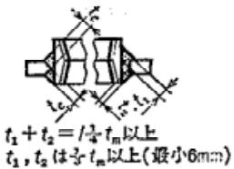
注：本図中 最下段に最小6mmとあるのは最大6mmの誤り
