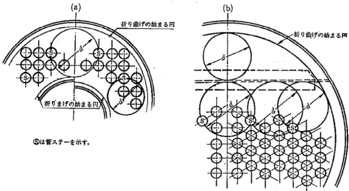
**23.3.8 発生器の燃焼室の管板の最小厚さ** 燃焼室の天井板が胴から支えられない場合であって、天井板に加わる荷重が管板に加わる場合の管板の最小厚さは、次の算式により得られる厚さ以上のこと。
