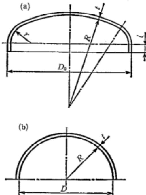
$R$  : 鏡板の内面の半径 (単位 mm)
