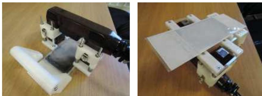
図 2—組立後の密閉型磁粉探傷装置（製品例）
