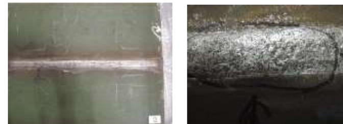
図6 マグ溶接による溶接ビード
