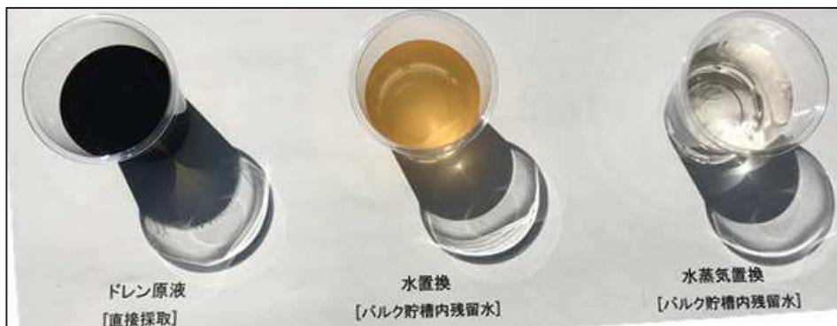
図 6.3.2-7 各置換方法によるバルク貯槽内部残留分の比較
