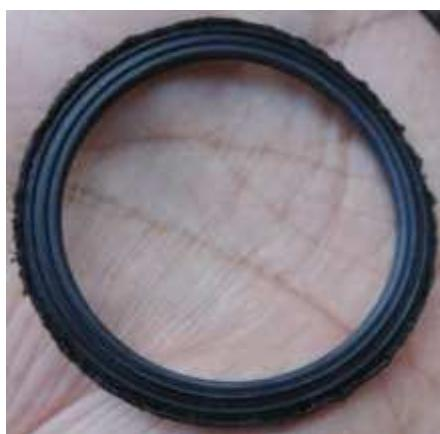
図 6.3.2-10 くず化するバルク貯槽の液面計から取り外したゴムパッキン
