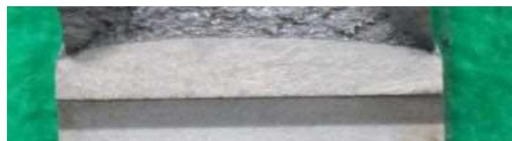
図 a20. 8 市販材溶接金属部試験片 CW-2 の疲労予き裂形状
