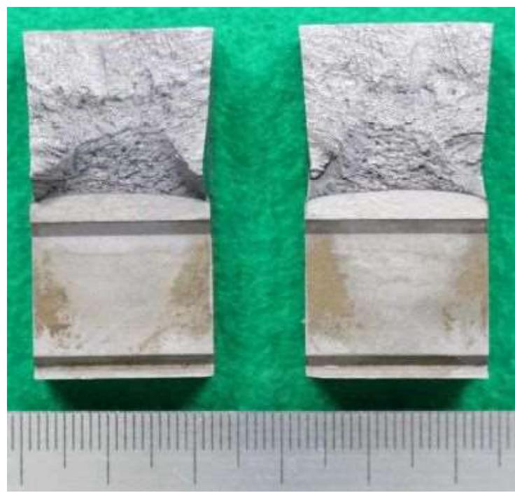
図 a19.8 市販材溶接金属部試験片 CW-2 の破面外観
