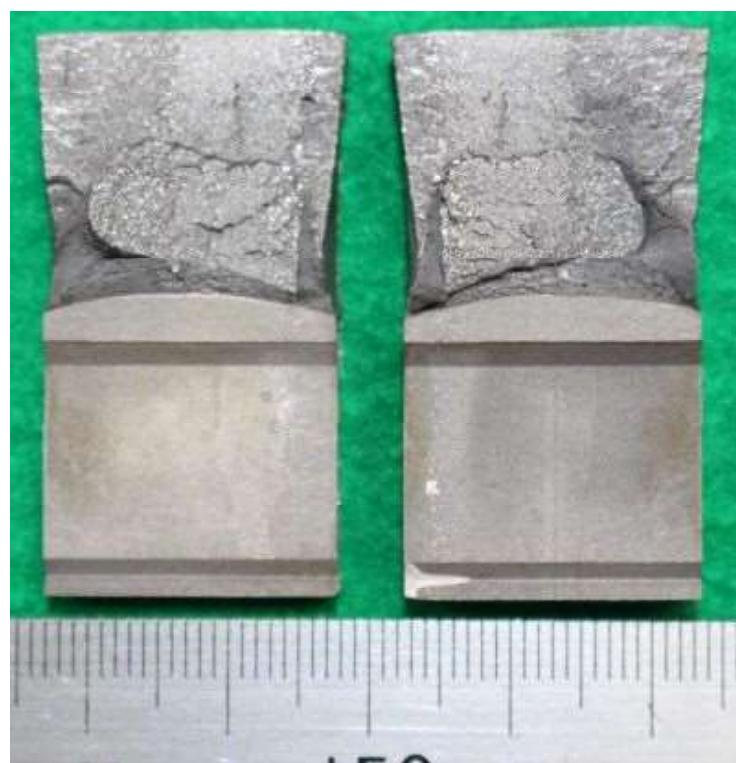
図 a19.4 市販材ボンド部試験片 CF-2 の破面外観
