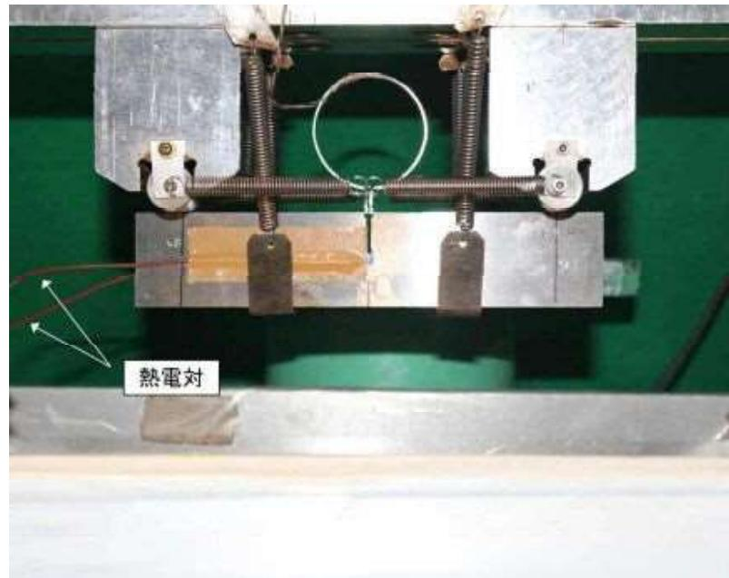
図 6.18 試験片組付時写真
