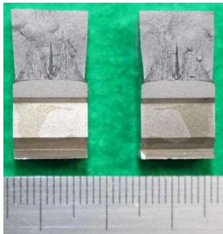
図 a19.11 解体材母材部試験片 MB-2 の破面外観
