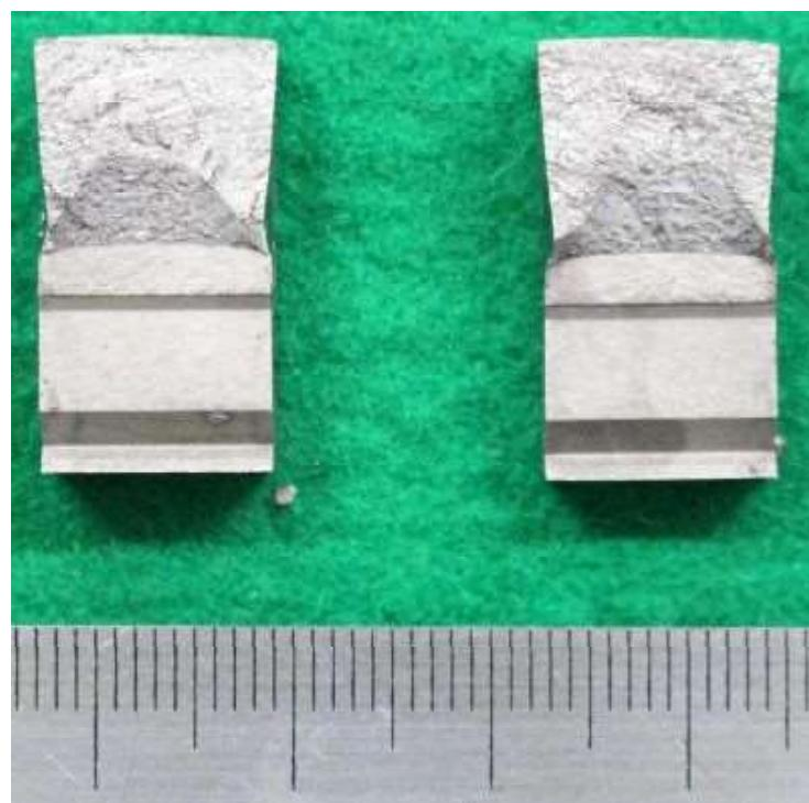
図 a19.16 解体材溶接金属部試験片 MW-1 の破面外観
