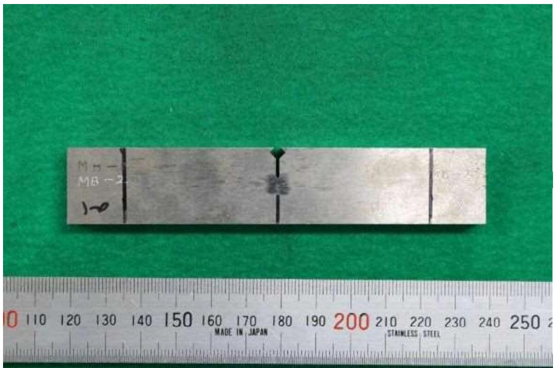
図 a15.11 解体材母材部試験片 MB-2
