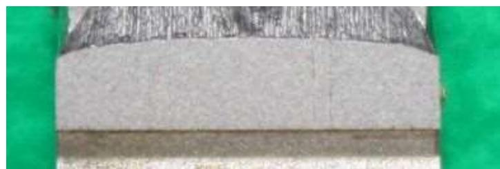
図 a20.11 解体材母材部試験片 MB-2 の疲労予き裂形状
