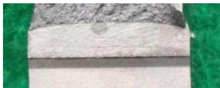
図 a20.17 解体材溶接金属部試験片 MW-2 の疲労予き裂形状
