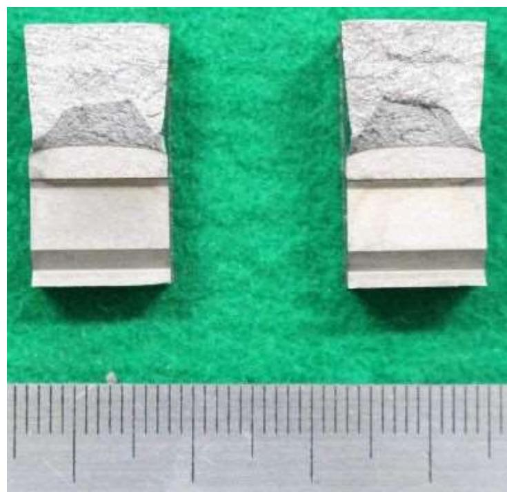
図 a19.18 解体材溶接金属部試験片 MW-3 の破面外観
