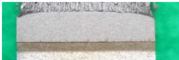
図 a20.12 解体材母材部試験片 MB-3 の疲労予き裂形状
