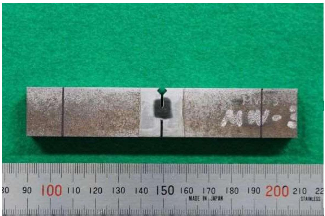
図 a15.18 解体材溶接金属部試験片 MW-3
