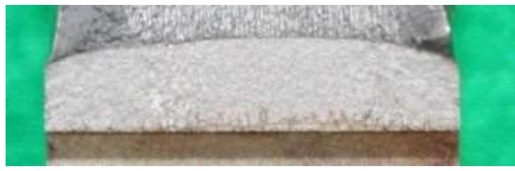
図 a20.13 解体材ボンド部試験片 MF-1 の疲労予き裂形状
