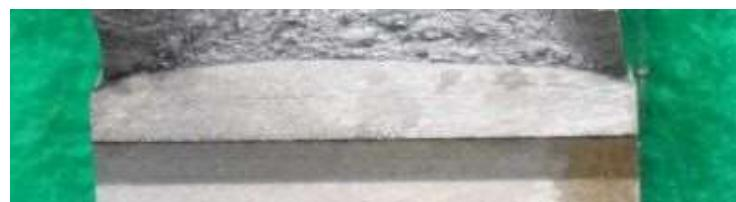
図 a20. 9 市販材溶接金属部試験片 CW-3 の疲労予き裂形状
