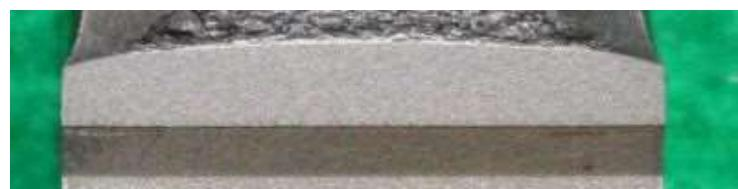
図 a20.2 市販材母材部試験片 CB-2 の疲労予き裂形状
