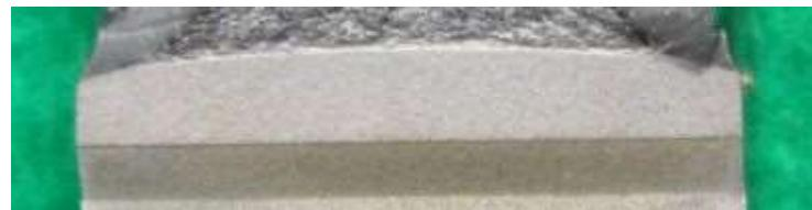
図 a20.1 市販材母材部試験片 CB-1 の疲労予き裂形状
