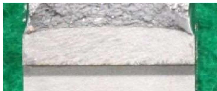
図 a20.16 解体材溶接金属部試験片 MW-1 の疲労予き裂形状
