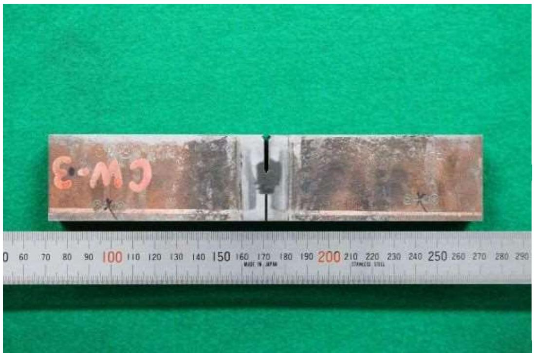
図 a15.9 市販材溶接金属部試験片 CW-3
