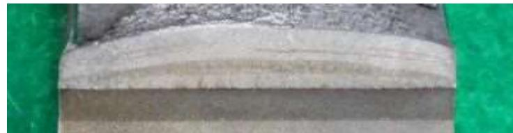
図 a20. 6 市販材ボンド部試験片 CF-4 の疲労予き裂形状
