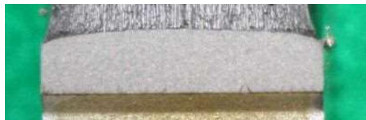
図 a20. 10 解体材母材部試験片 MB-1 の疲労予き裂形状
