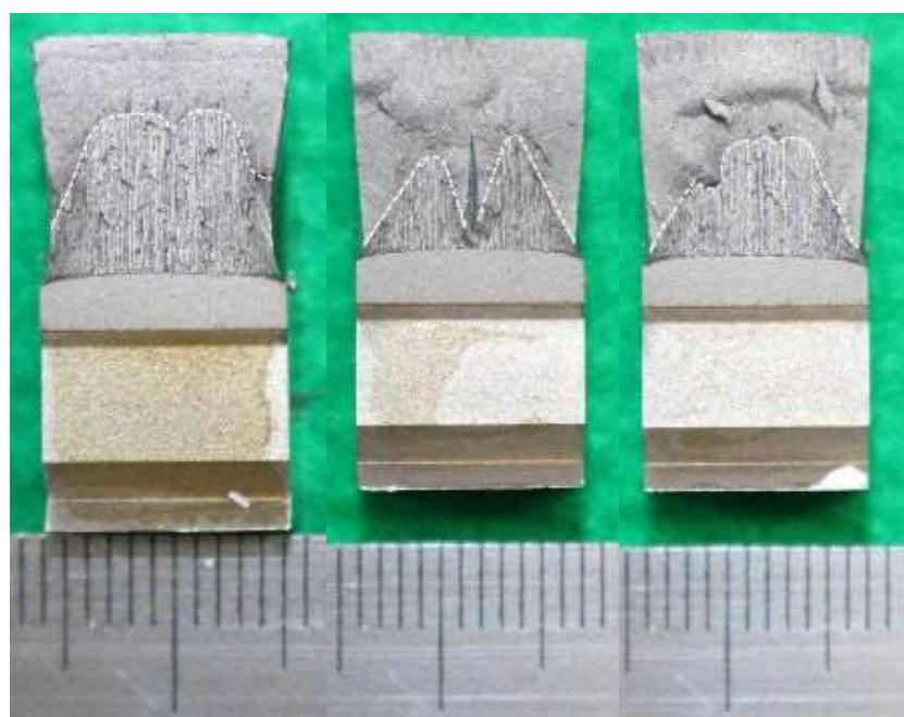
図 a21.4 解体材母材部試験片 MB 材の延性き裂先端トレース画像
