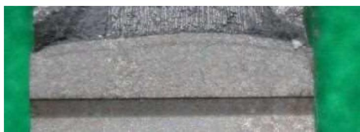
図 a20.14 解体材ボンド部試験片 MF-2 の疲労予き裂形状
