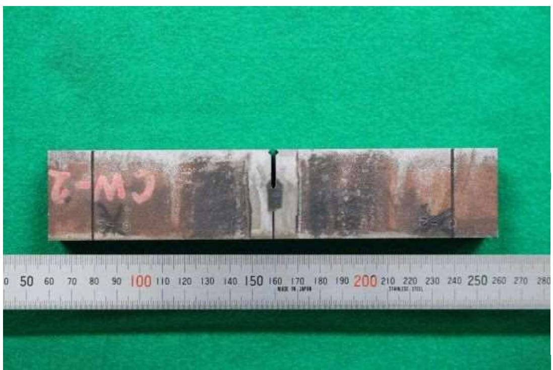
図 a15.8 市販材溶接金属部試験片 CW-2
