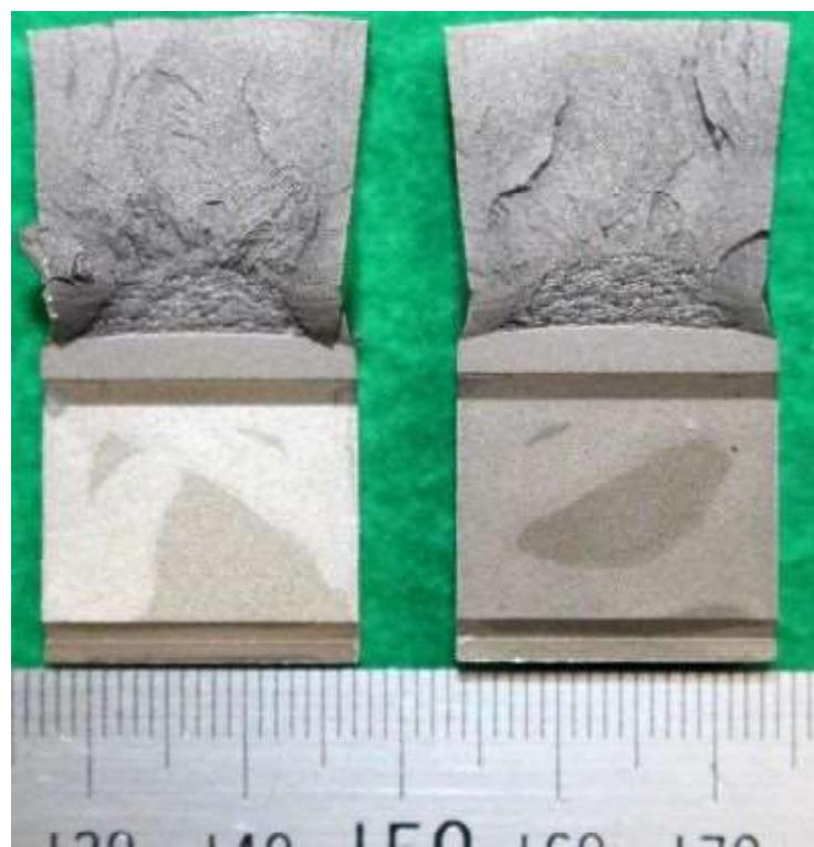
図 a19.2 市販材母材部試験片 CB-2 の破面外観
