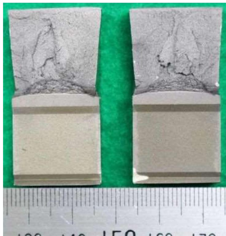
図 a19.1 市販材母材部試験片 CB-1 の破面外観
