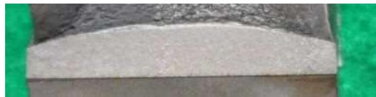
図 a20.5 市販材ボンド部試験片 CF-3 の疲労予き裂形状
