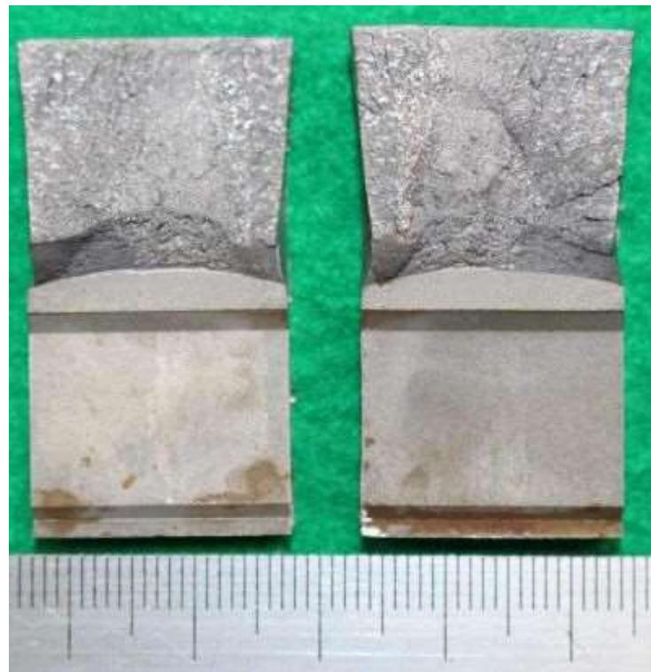
図 a19.5 市販材ボンド部試験片 CF-3 の破面外観
