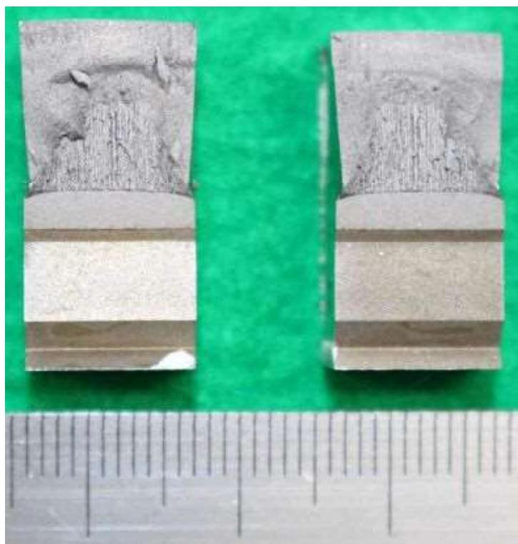
図 a19.12 解体材母材部試験片 MB-3 の破面外観
