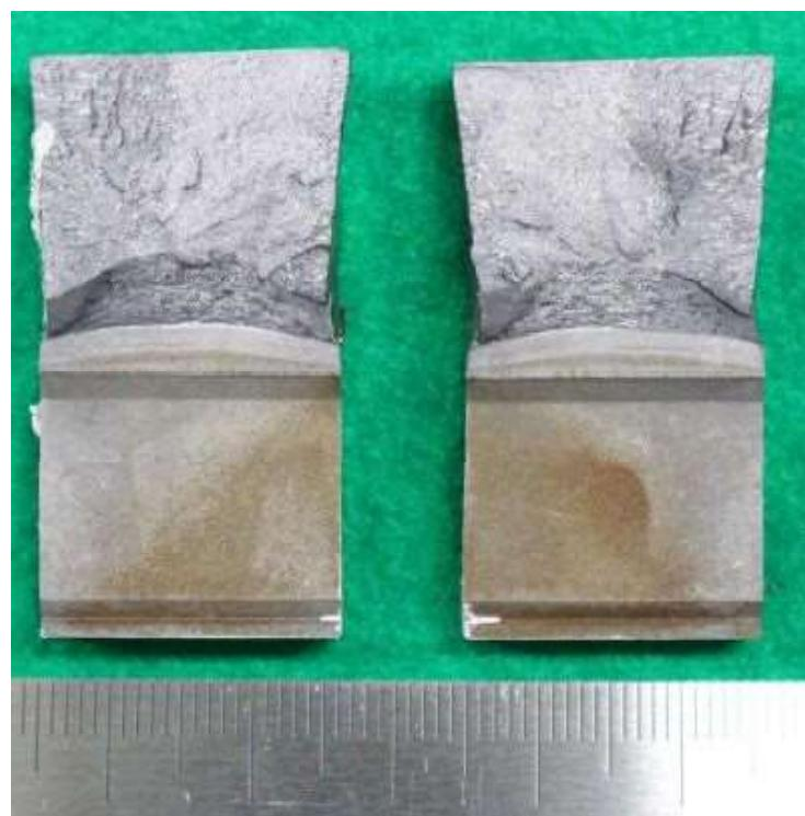
図 a19.6 市販材ボンド部試験片 CF-4 の破面外観
