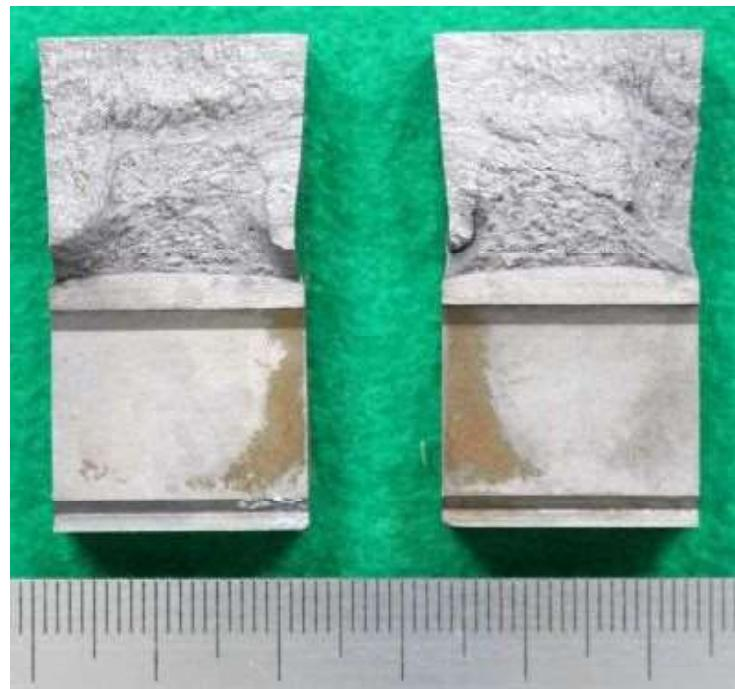
図 a19.9 市販材溶接金属部試験片 CW-3 の破面外観
