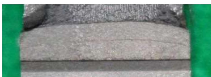
図 a20.15 解体材ボンド部試験片 MF-3 の疲労予き裂形状
