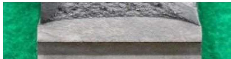
図 a20. 7 市販材溶接金属部試験片 CW-1 の疲労予き裂形状
