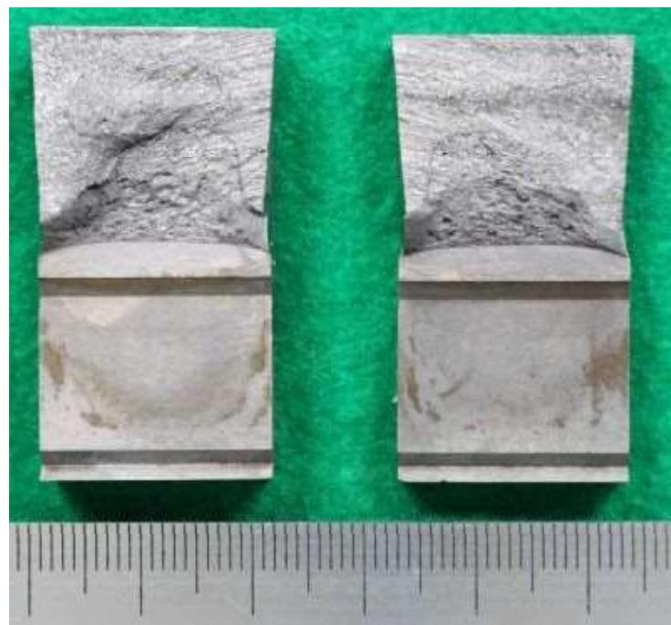
図 a19.7 市販材溶接金属部試験片 CW-1 の破面外観
