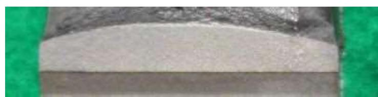
図 a20.4 市販材ボンド部試験片 CF-2 の疲労予き裂形状
