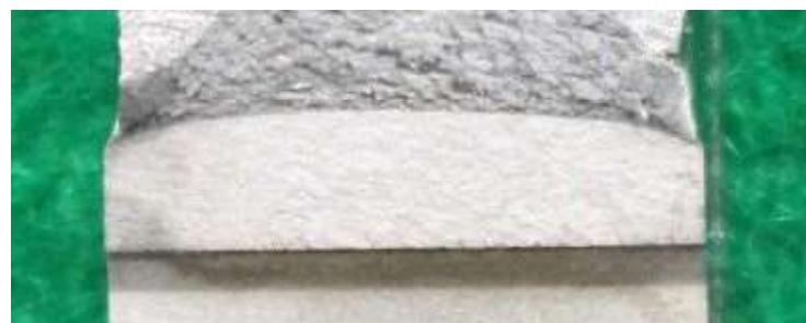
図 a20.18 解体材溶接金属部試験片 MW-3 の疲労予き裂形状
