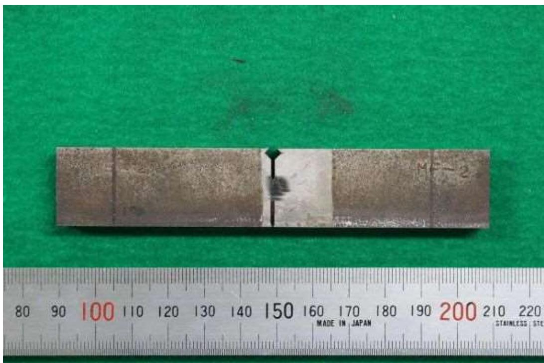
図 a15.14 解体材ボンド部試験片 MF-2
