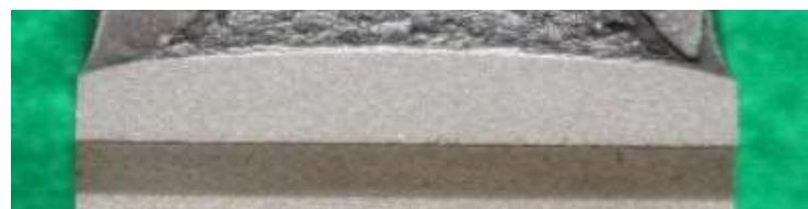
図 a20.3 市販材母材部試験片 CB-3 の疲労予き裂形状
