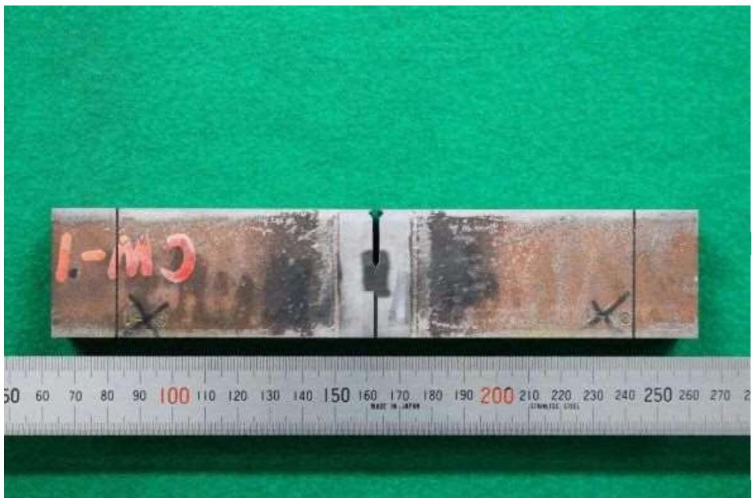
図 a15.7 市販材溶接金属部試験片 CW-1
