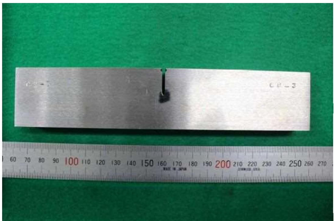
図 a15.3 市販材母材部試験片 CB-3
