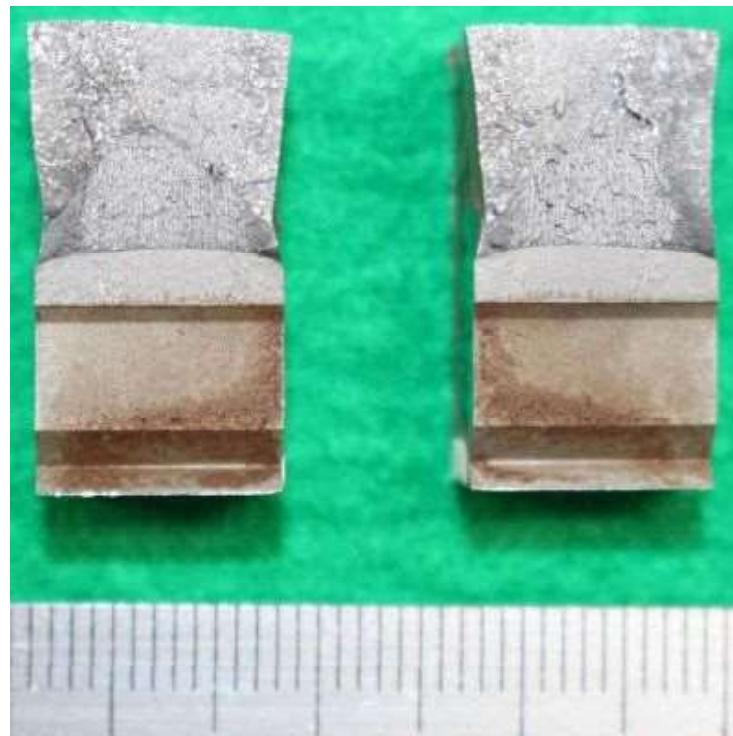
図 a19.13 解体材ボンド部試験片 MF-1 の破面外観
