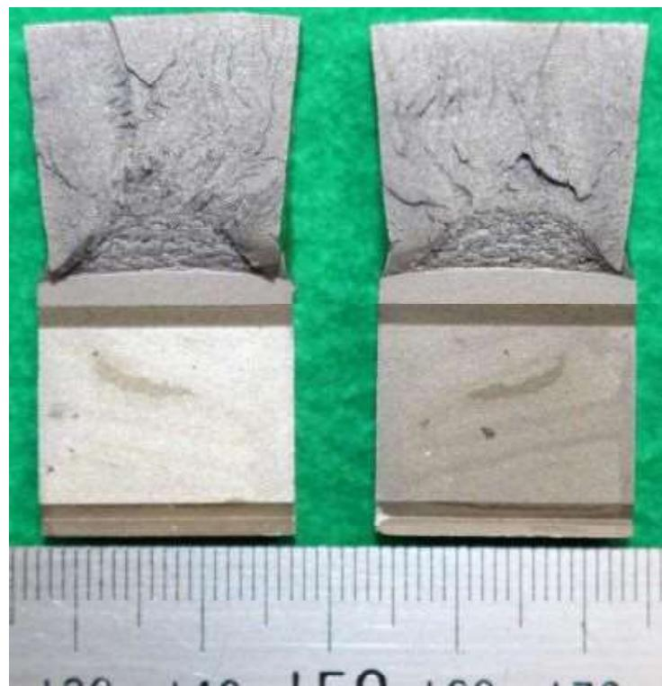
図 a19.3 市販材母材部試験片 CB-3 の破面外観
