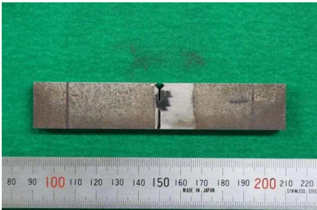
図 a15.13 解体材ボンド部試験片 MF-1
