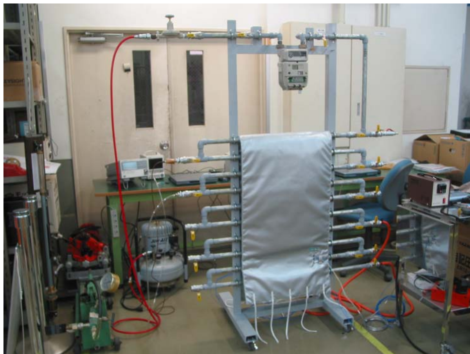
写真 7.1.2.3 LPガス配管モデル
