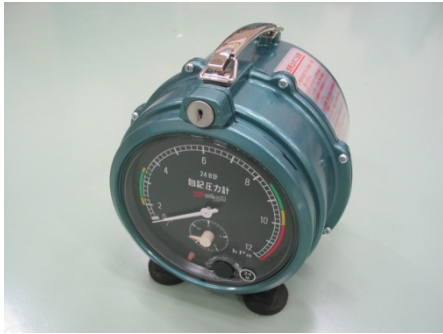
写真 7.2.1.2 機械式自記圧力計（左）と電気式ダイヤフラム式自記圧力計
