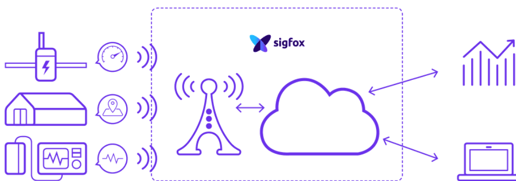
図 7.1.3-6 SIGFOX のシステム構成図
