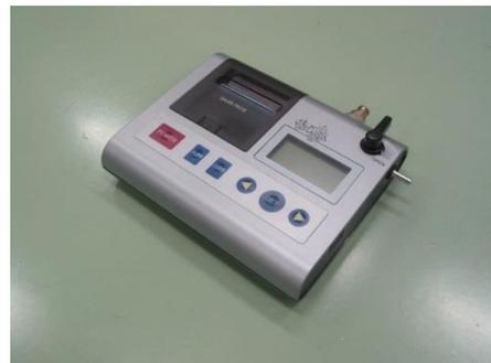
写真 7. 1. 1. 2 機械式自記圧力計（左）と電気式ダイヤフラム式自記圧力計
