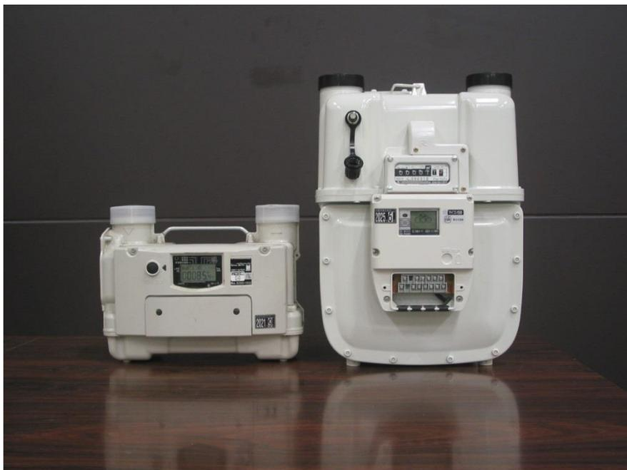
写真 7.2.1.8 業務用マイコンメータ (膜式(右)と超音波式)
