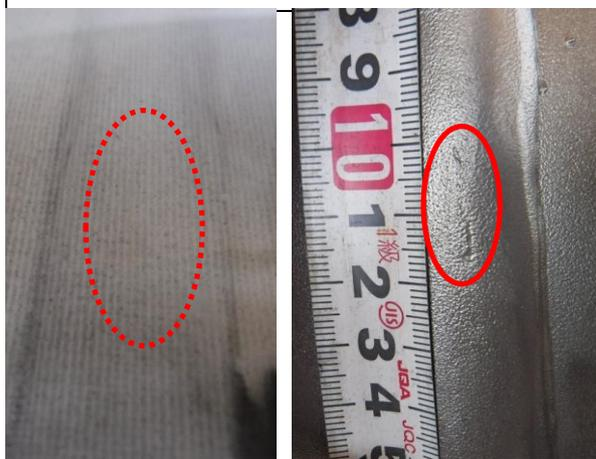
密閉型磁粉探傷試験 予備検査
