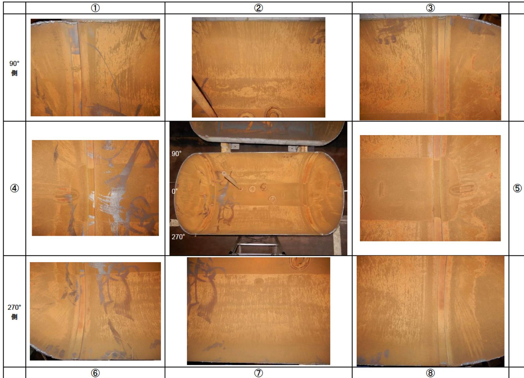
図 6.2.4-8 被試験体内面状況 A-2 (上部)
