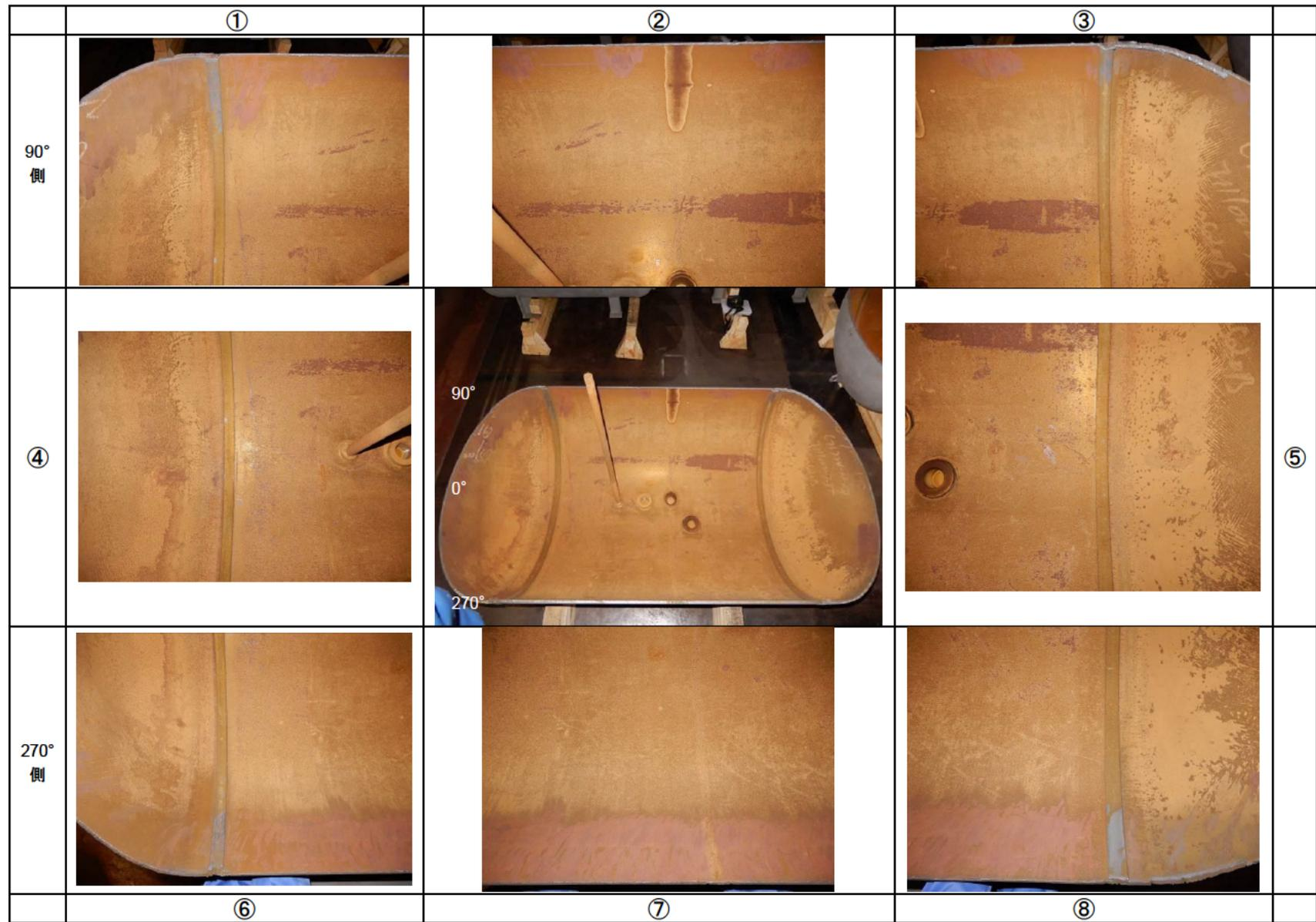
図 6.2.4-20 被試験体内面状況 B-4 (上部)
