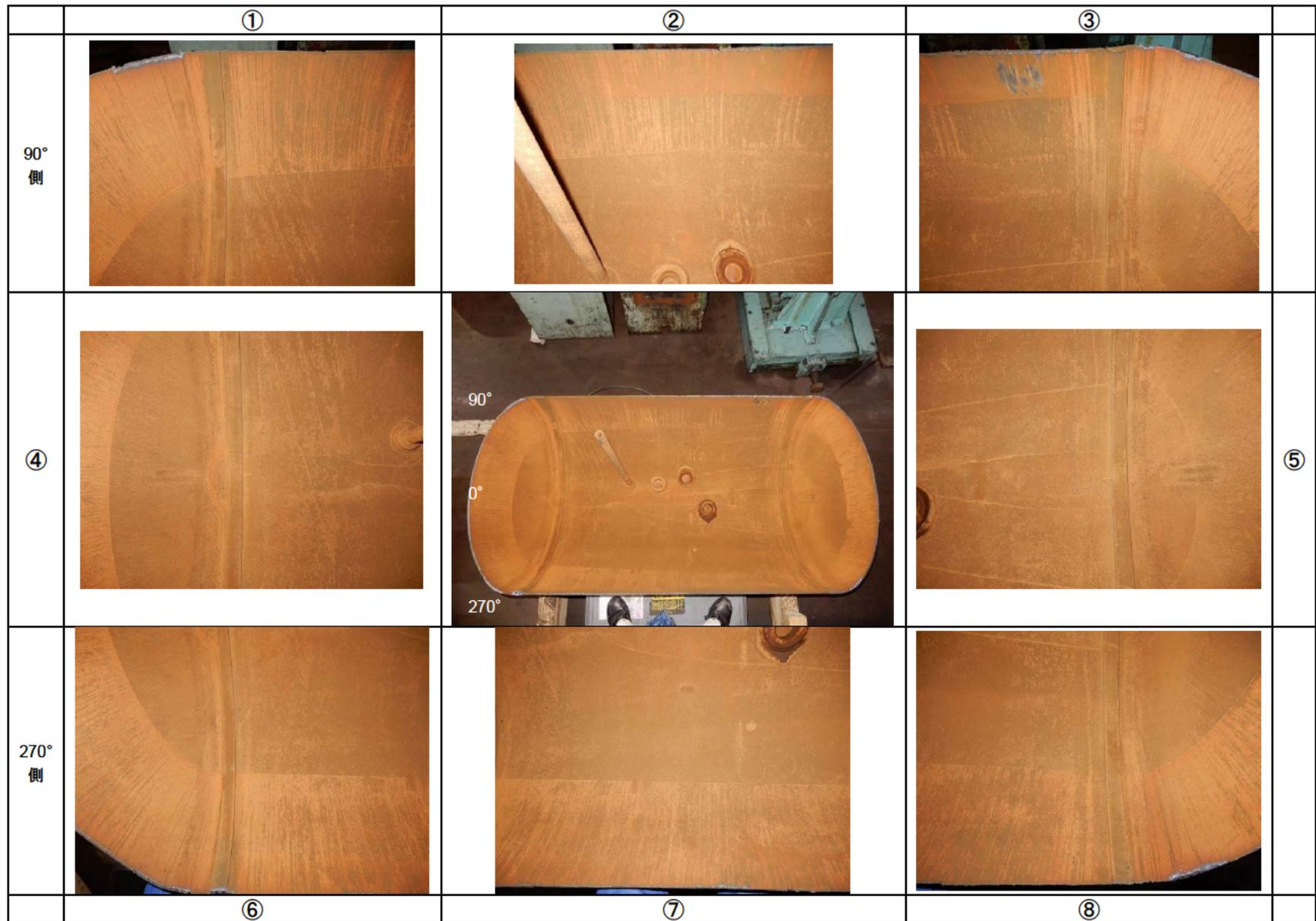
図 6.2.4-12 被試験体内面状況 A-4 (上部(耐圧試験実施))
