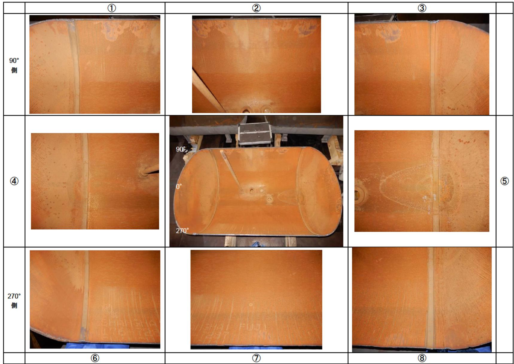
図 6.2.4-16 被試験体内面状況 B-2 (上部 (耐圧試験実施))
