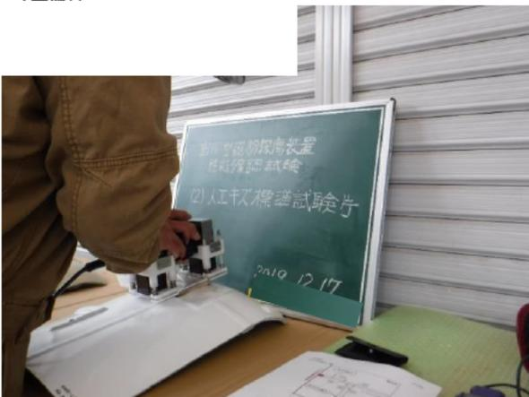
密閉型磁粉探傷試験 予備検査
