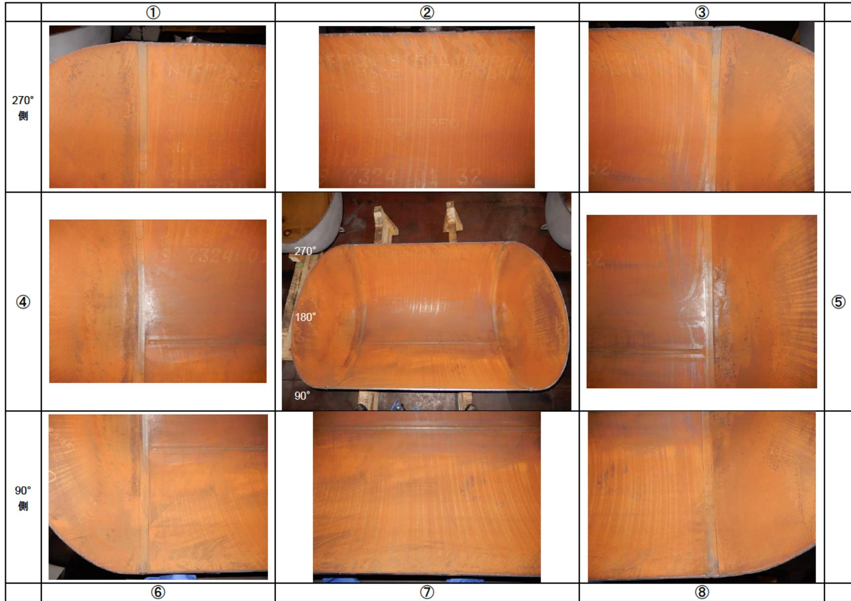
図 6.2.4-17 被試験体内面状況 B-2 (下部 (耐圧試験実施))
