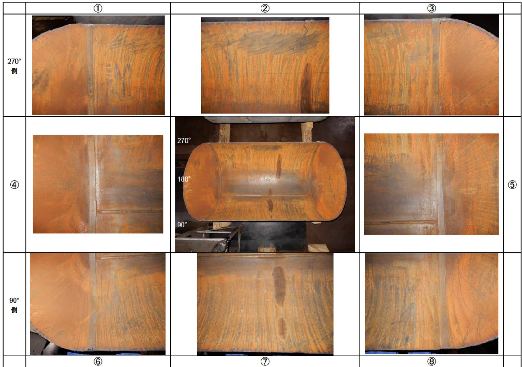
図 6.2.4-13 被試験体内面状況 A-4 (下部(耐圧試験実施))
