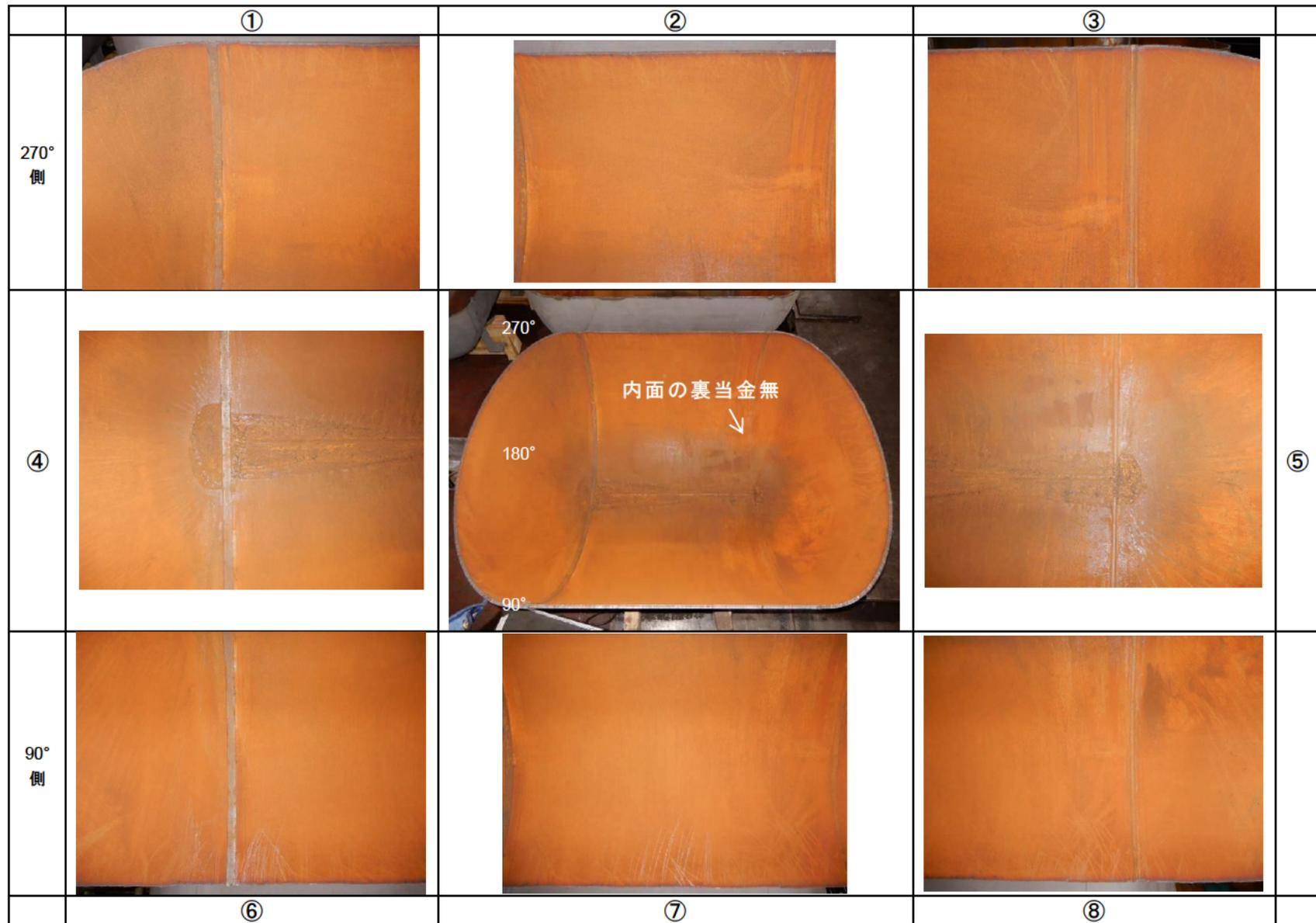
図 6.2.4-23 被試験体内面状況 C-1 (下部 (耐圧試験実施))
