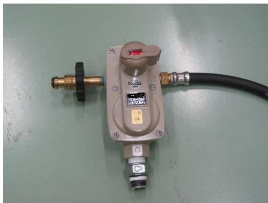
写真 7.1.2 単段式調整器（左）と自動切替式一体型調整器
