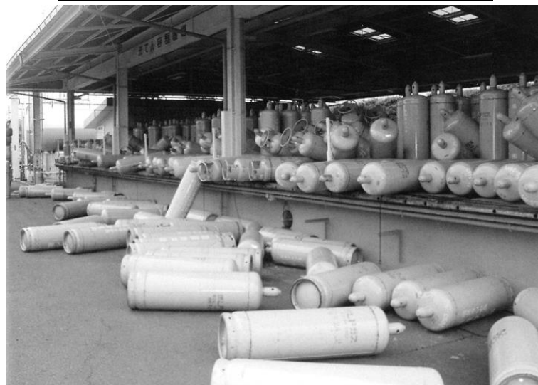
東日本大震災時における充填所での容器の転倒・転落
