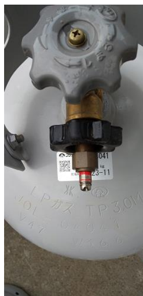
（中） 高圧ホースがちぎれているが、張力式の高圧ホースが動作している
