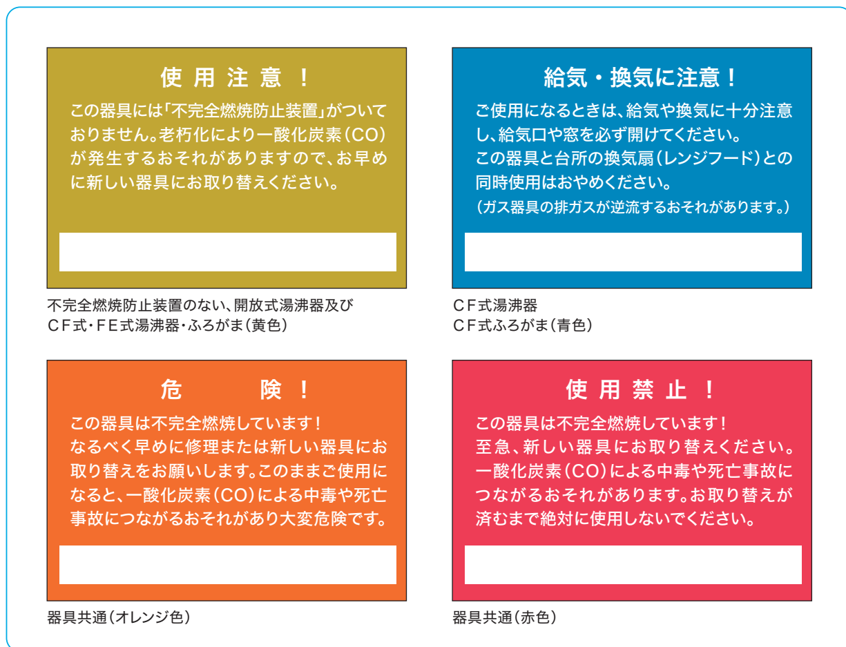
図4-21 判定シールの例
