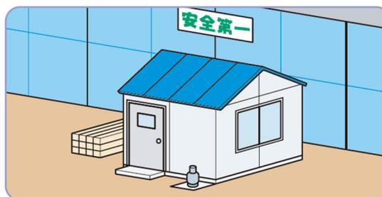
図5-4 工事事務所で8kg容器を使用の例
