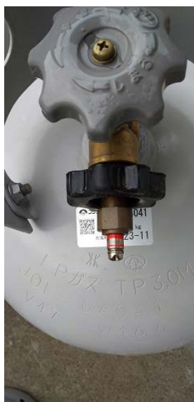
（中）高圧ホースがちぎれているが、張力式の高圧放出防止機構が作動している
