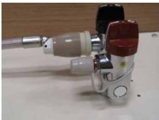
ホースエンド口に装着したガス栓キャップ
