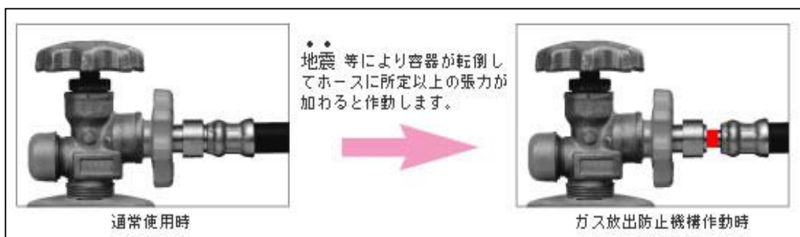
図1.32 張力式ガス放出防止型高圧ホース
