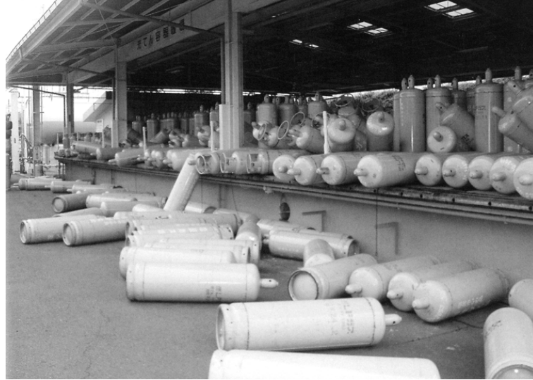
東日本大震災の地震で倒れプラットホームから落下した LP ガス容器（石油産業新聞社提供）
