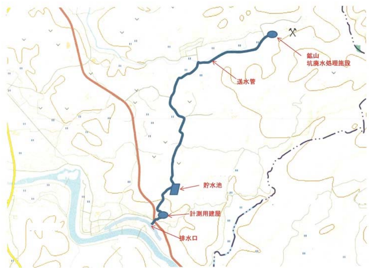
坑廃水排水ルート(坑廃水処理施設～排水口)
