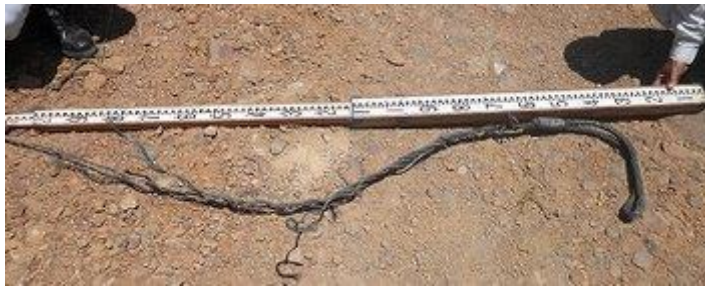
引きちぎられた様に道路に落ちていたワイヤー (約 2.2m)
