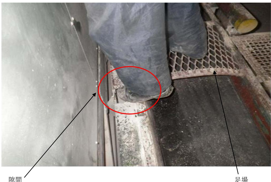
ベルトコンベア脇のカバーの隙間に取られた左足（再現）
