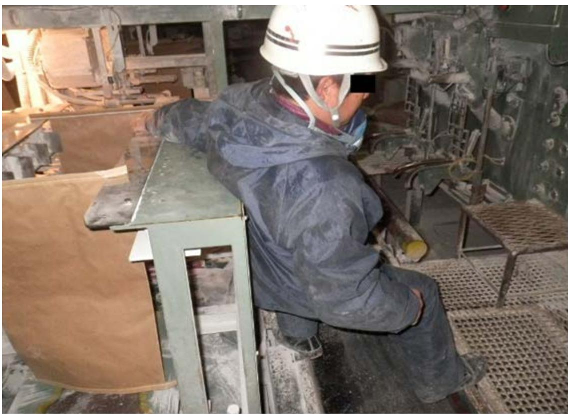
バランスを崩して背中を自動給袋機に強打した罹災者（再現）
