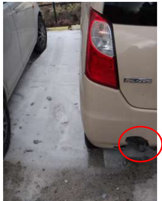
車両(バンパー)破損状況(○印)
