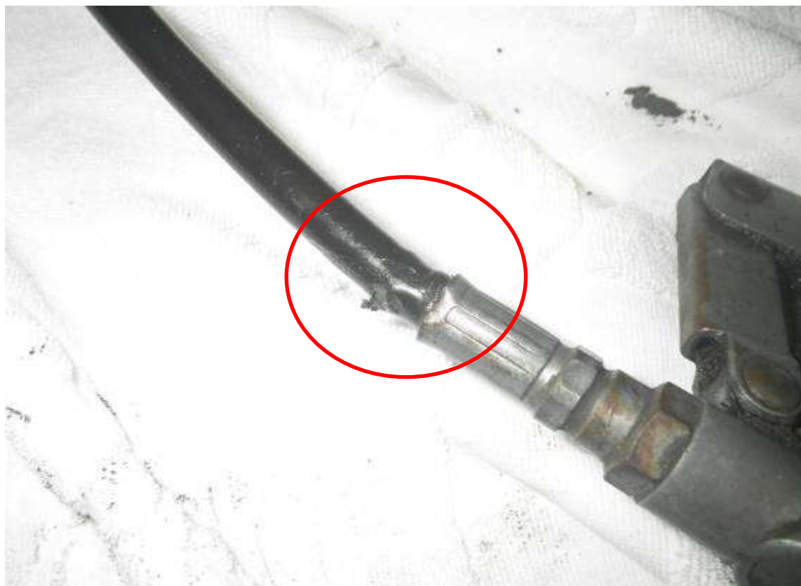
Fig.2 グリスホース根元のピンホール発生箇所
