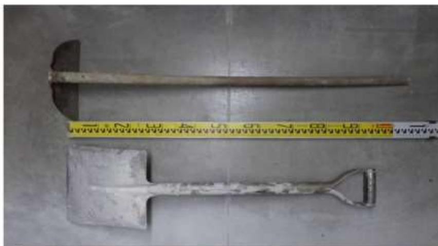
写真4 居付き除去作業に使用した工具(写真は同型のもの)
