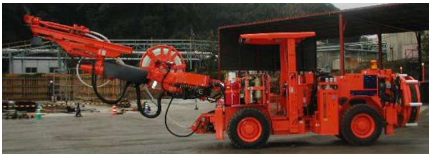
ケーブルインストーラー全景
