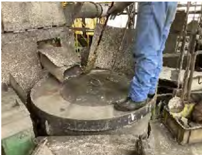
写真1 蒼鉛精製炉（罹災箇所）の上に蓋が付いている状況
