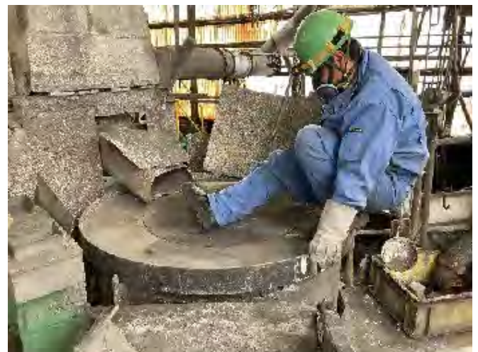
写真1 蒼鉛精製炉（罹災箇所）の上に蓋が付いている状況
