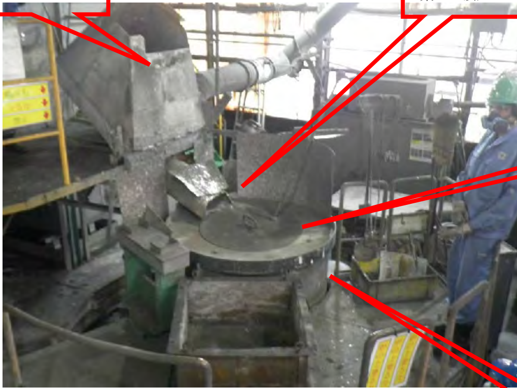
写真1 蒼鉛精製炉（罹災箇所）の上に蓋が付いている状況
