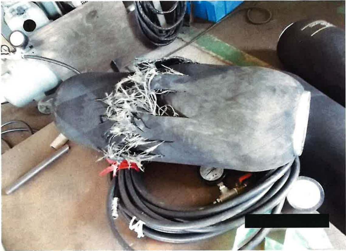
【破裂した止水プラグの状況】
