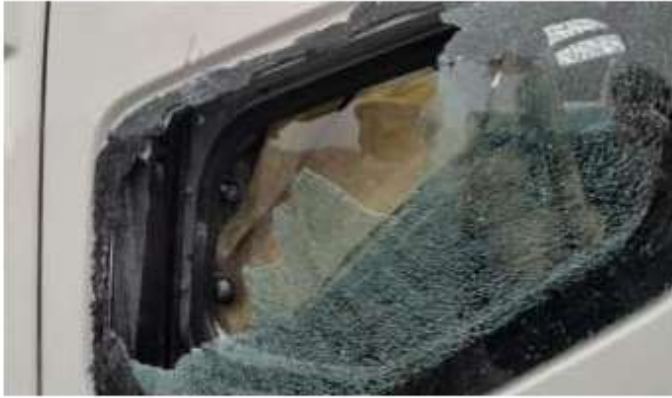
写真 2-2：左側ドア足元ガラス破損
