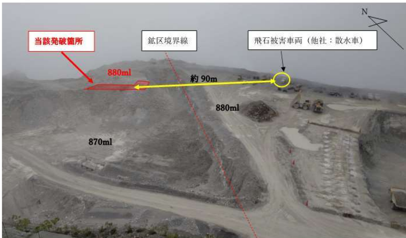
写真1：発破箇所と被害車両位置
