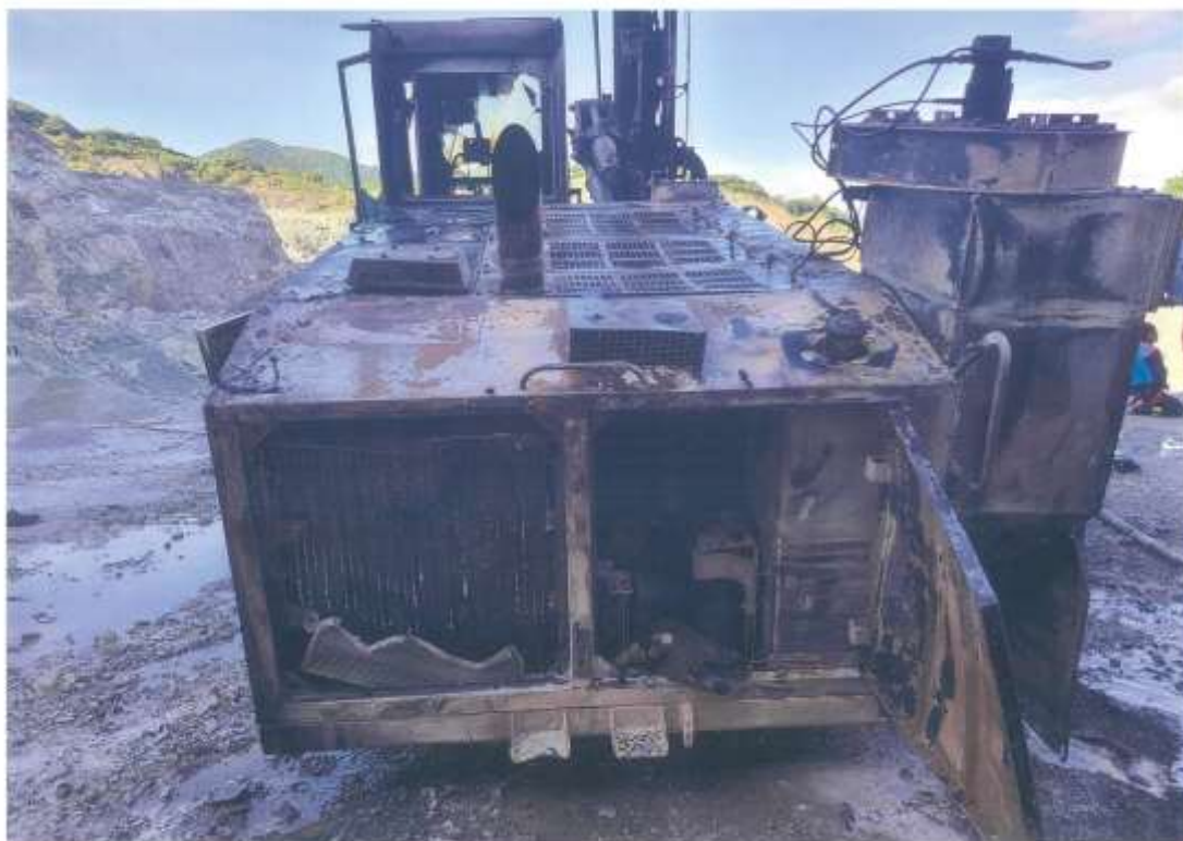
写真3 消火後のクローラードリル（機体後方）
