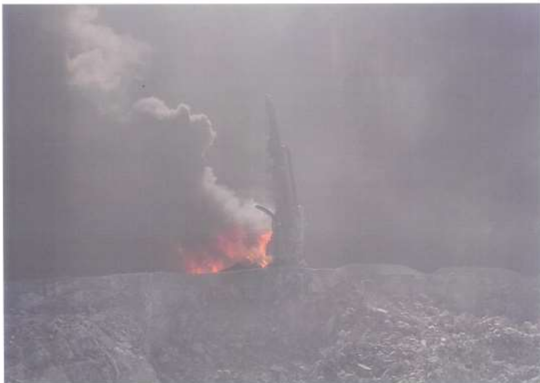
写真1 延焼中のクローラードリル
