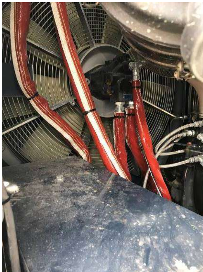
写真6 改善対策③-2 エンジンルーム右側後方コンプレッサー及び作動油ファンモーターホースカバー
