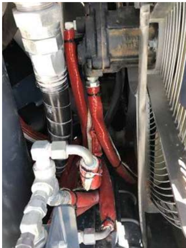
写真6 改善対策③-2 エンジンルーム右側後方コンプレッサー及び作動油ファンモーターホースカバー
