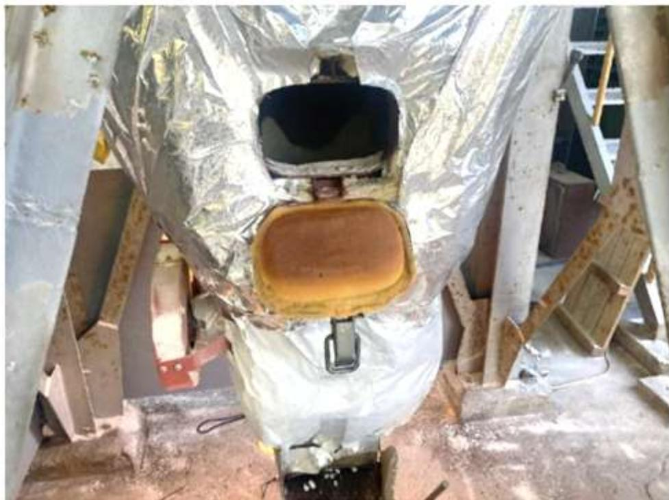
写真4：点検窓内部（ロータリーバルブの羽）
