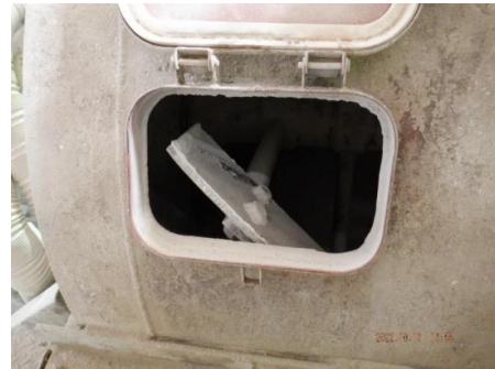
写真4 点検口（拡大） （点検口と羽根までの距離（間隔）約3cm）
