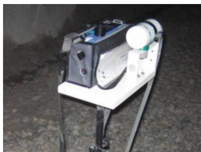
写真 1 質量濃度測定器と相対濃度測定器の併行測定時のセット例
